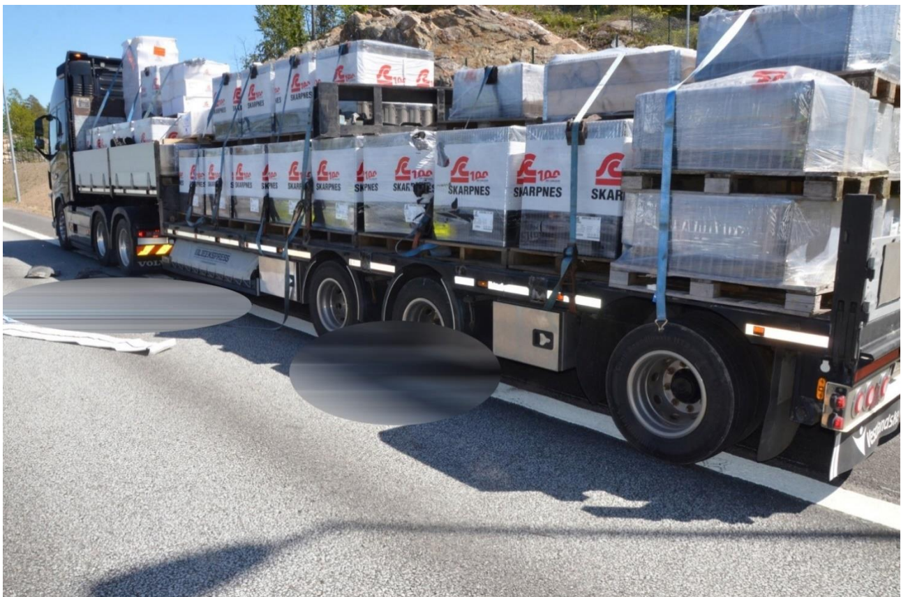
Figur 14: Vogntoget, bestående av trekkbil og semitrailer. Den bakerste jekkestroppen henger løst, og vogntogføreren var i ferd med å sikre denne da ulykken inntraff. Foto: Politiet
