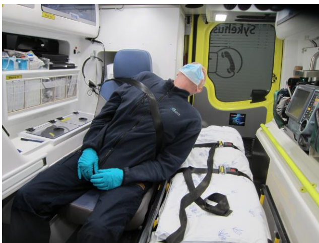
Figur 12: Rekonstruksjon med kraftpåvirkning bak på venstre side (tilsvarende aktuelle ulykke). Aktuell belteføring (over høyre skulder). Foto: SHK
