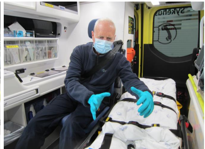
Figur 19: Rekonstruksjon med pasientbehandling (utstrakt belte), og med kraftpåvirkning i front. Motsatt belteføring (over venstre skulder). Foto: SHK
