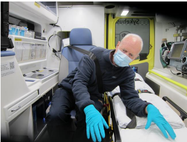
Figur 18: Rekonstruksjon med pasientbehandling (utstrakt belte), og med kraftpåvirkning i front. Aktuell belteføring (over høyre skulder). Foto: SHK
