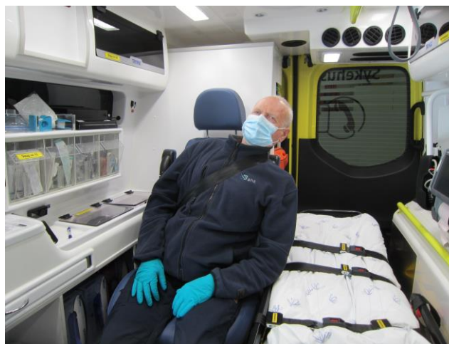
Figur 13: Rekonstruksjon med kraftpåvirkning bak på venstre side (tilsvarende aktuelle ulykke). Motsatt belteføring (over venstre skulder). Foto: SHK
