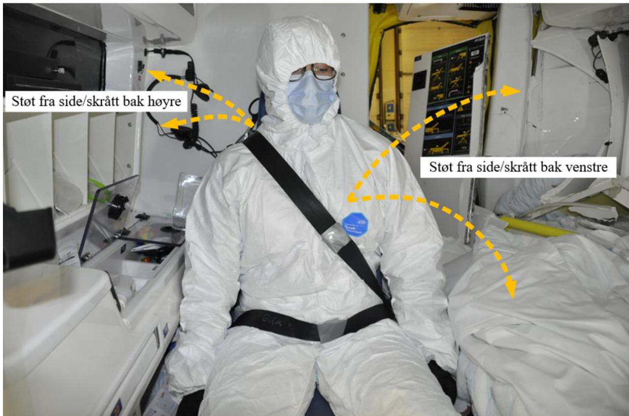
Figur 10: Rekonstruksjon av bevegelsene til legevaktlegen, som satt i ledsagerstolen, som følge av påkjørselen. Foto: SHK
