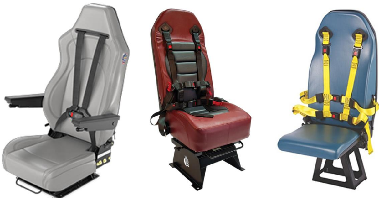
Figur 11: Eksempler på ulike belteløsninger på ledsagerstoler fra to forskjellige produsenter. Kilde: United Safety & Survivability Corp, EVS, Be-Ge
