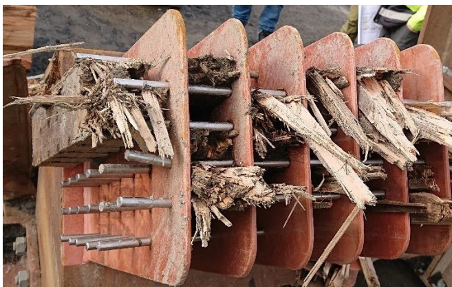
Figur 132 Knutepunkt UG15A ved innfestingen av diagonal 6A
