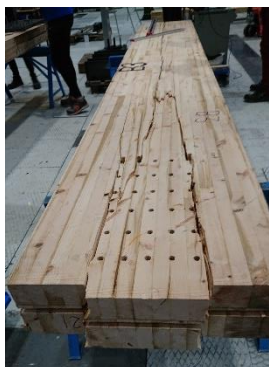
Figur 149 Blokkutrivning. Forsøk med diagonal 13.
