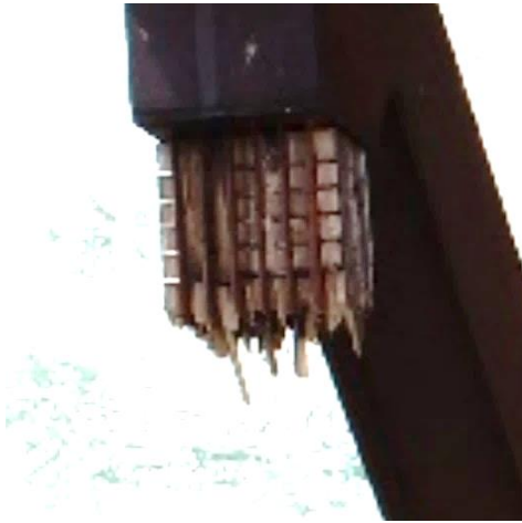
Figur 134 Knutepunkt OG14B, fra drone 8 timer etter kollaps
