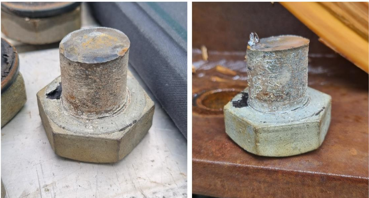
Figur 14 Brudd i bolter
