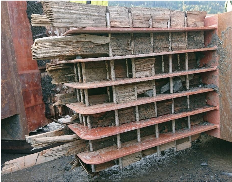
Figur 137 Knutepunkt UG15B, feste av diagonal 6B
