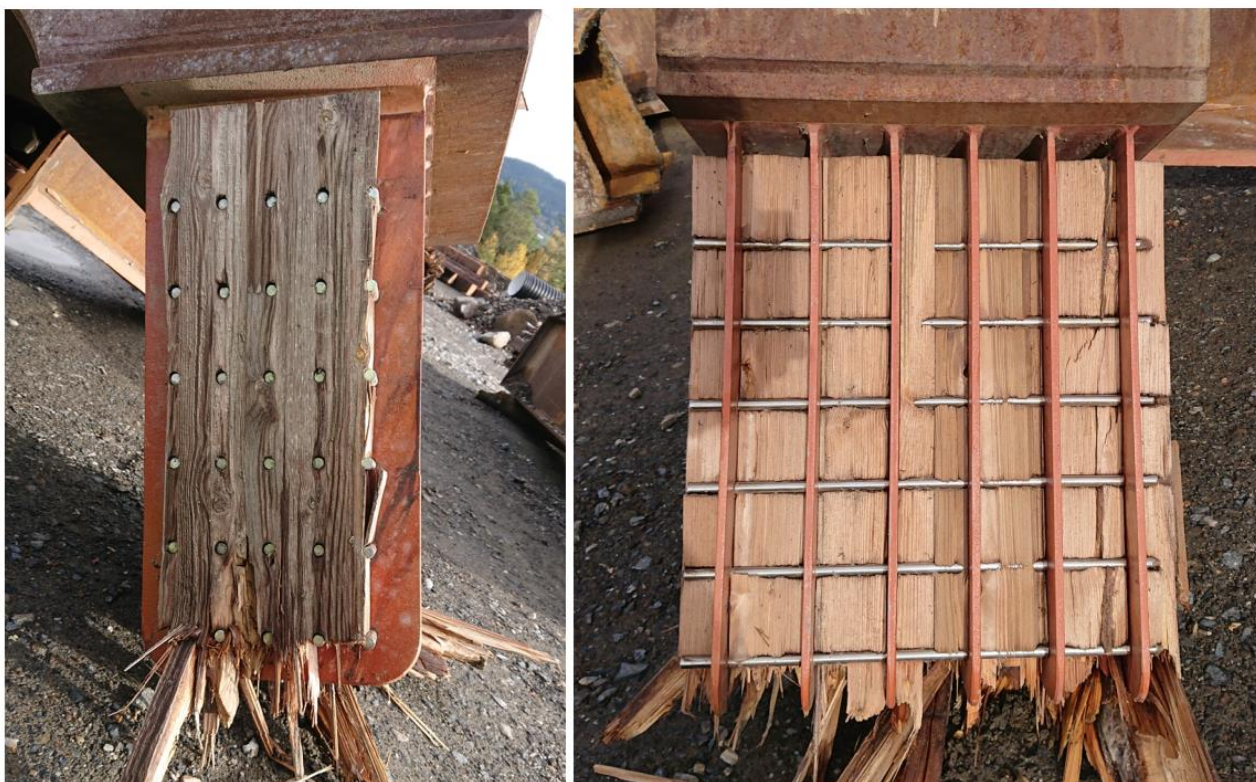
Figur 9 Knutepunkt K-17.b viser et rent blokk-skjærbrudd
