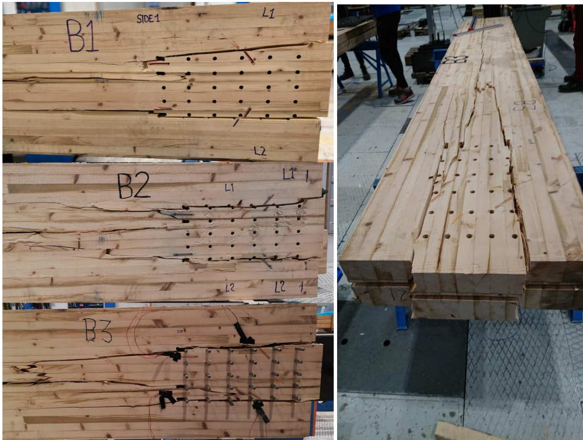
Figur 123 Bruddsoner i prøvestykkene
