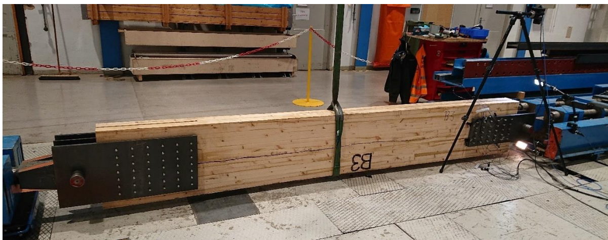
Figur 118 Prøvestykke for blokkutrivning (B) montert i prøveriggen for aksial strekkbelastning.
