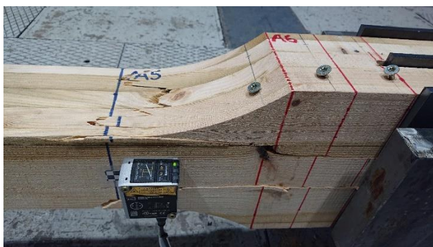
Figur 111 Strekkprøving, brudd ved innfestingen.
