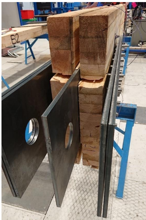
Figur 122 Blokkutrivning av dybelgruppe etter testing.
