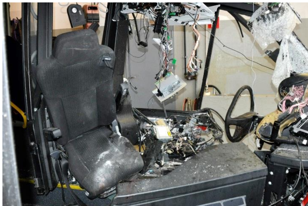
Figur 4: Førerplass i Buss 113. Førerstol er presset bakover som følge av inntrengingen. Foto: SHK
