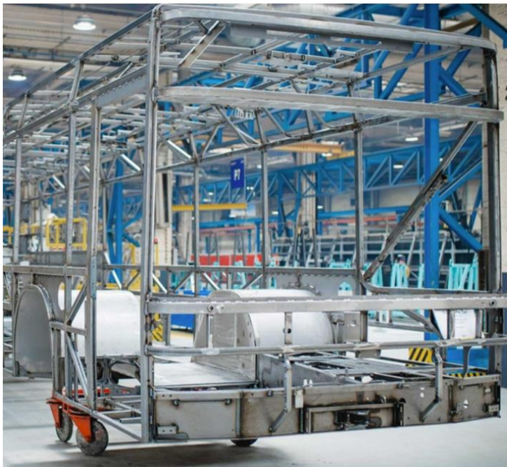
Figur 8: Karosseri og superstruktur, og chassi på laventrebuss. Kilde: MAN
