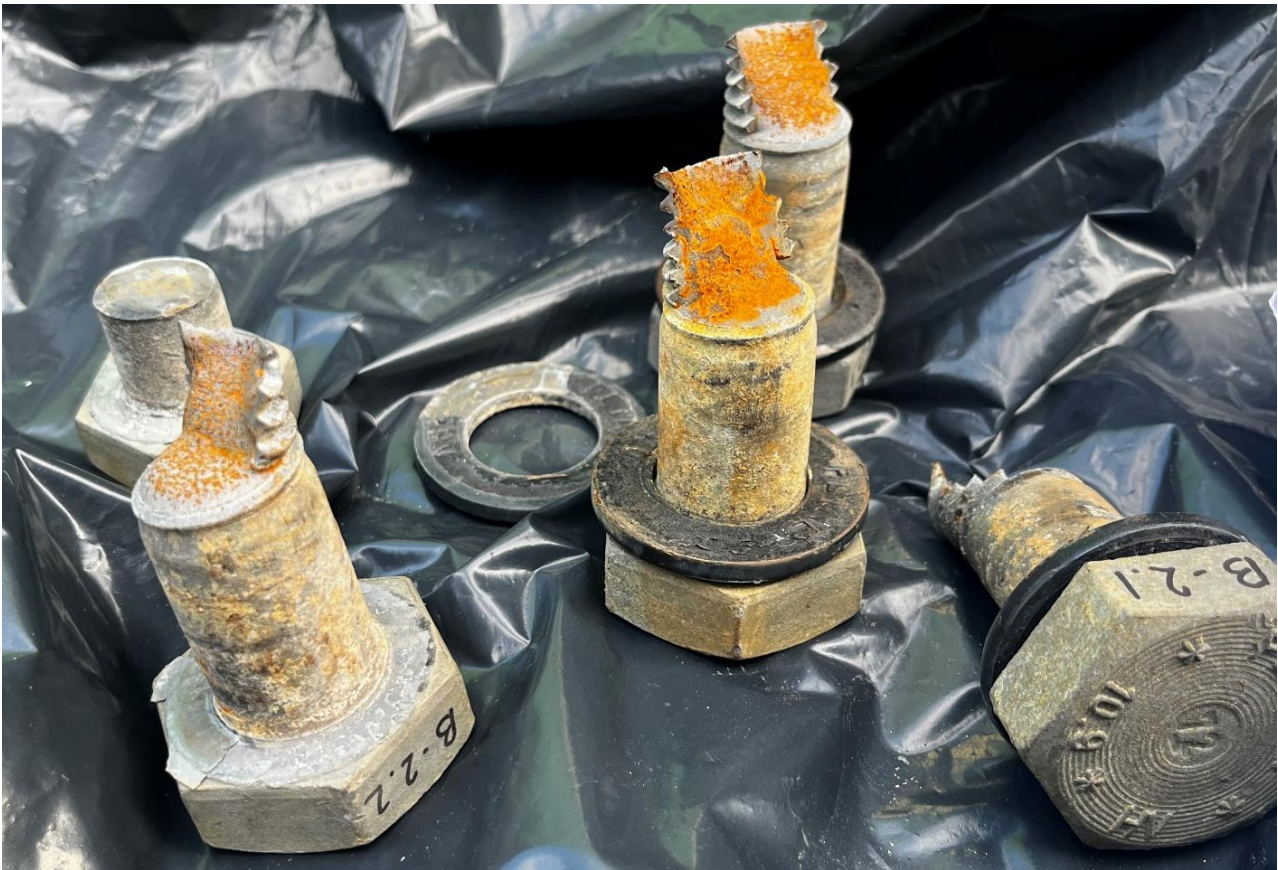
Figur 6: Halve bolter som ble hentet ut 18. august og sendt til SINTEF for videre undersøkelser. Foto: Havarikommisjonen
