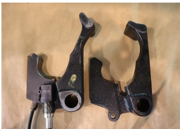
Figur 5: Låsekjeft. Skadet eksemplar til venstre, nytt til høyre. Foto: SHK
