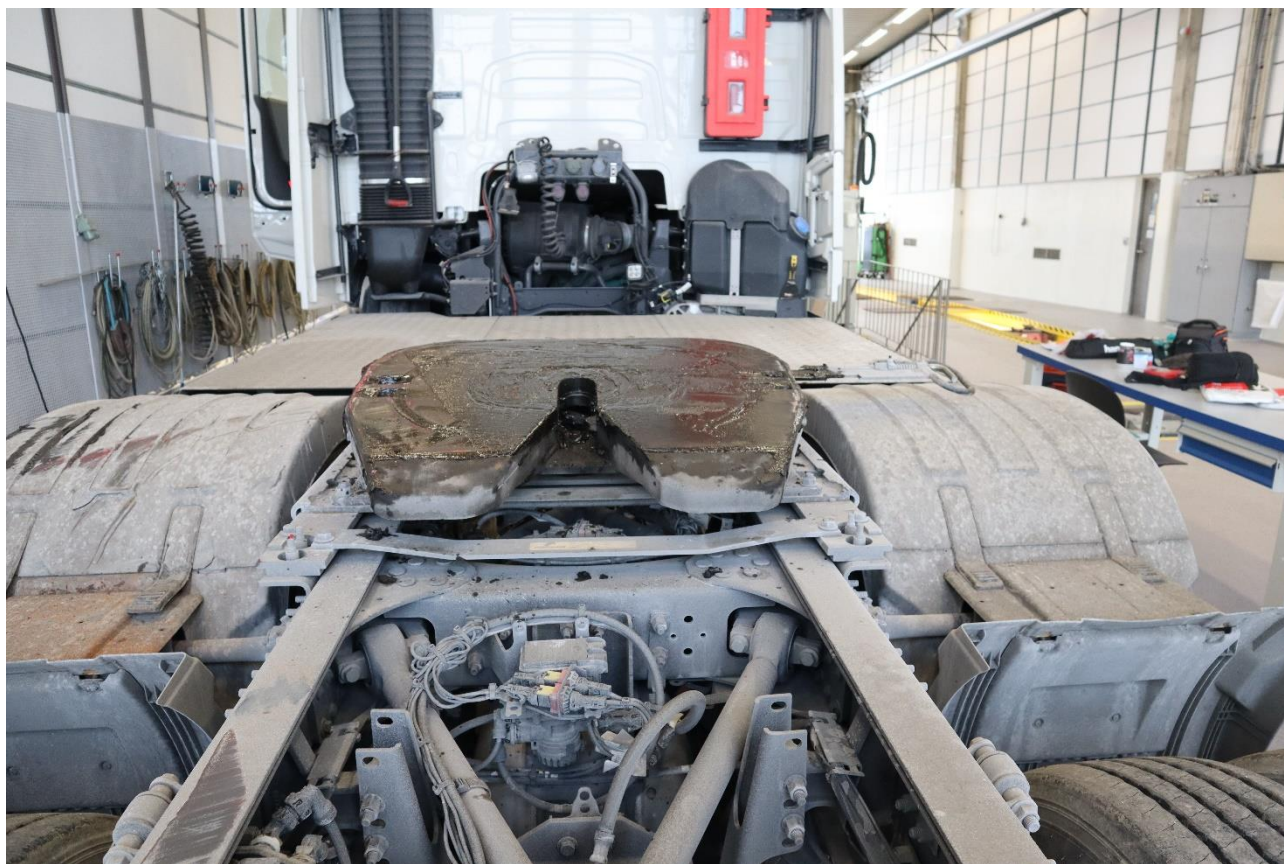
Figur 1: En svingskive er en anordning på en trekkbil for påkobling av en semitrailer. Semitraileren hviler på svingskiven, og er låst til svingskiven med en koblingsbolt («king pin»). Foto: SHK
