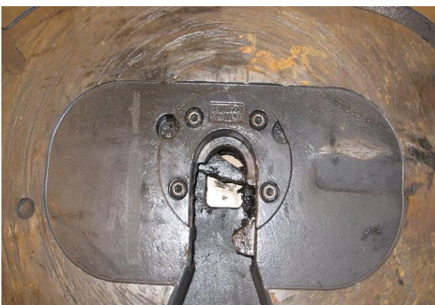
Figur 4: Sprekkdannelse og bulk på svingskivens glideflate, til høyre for låsesystemet. Foto: SHK
