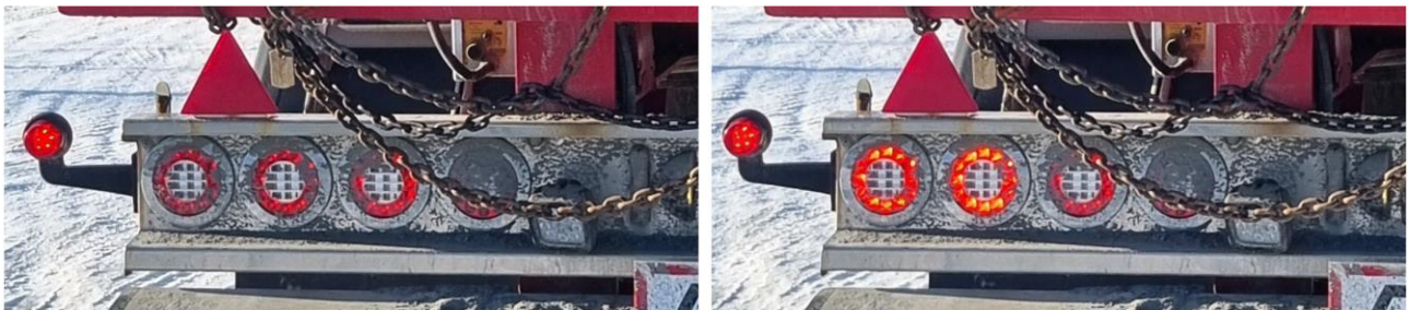
Figur 38: Kjørelys og bremselys etter test. Foto: Statens vegvesen
