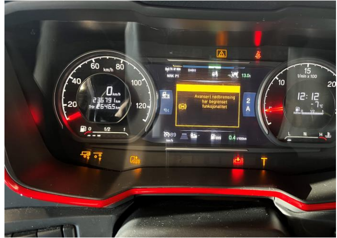
Figur 37: «Avansert nødbremning har begrenset funksjonalitet» (AEB). Foto: SHK
