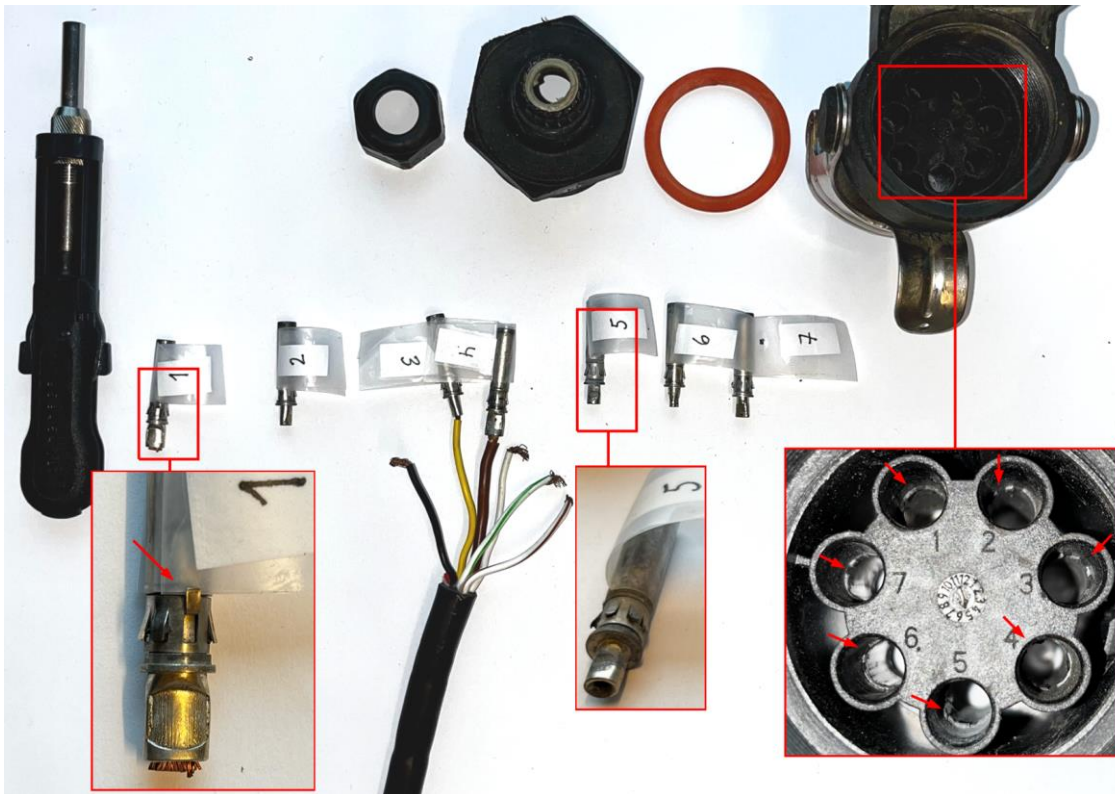
Figur 41: Åpning av kontakt. Vrengt motholdslås til PIN 1, variasjon i klemming mot ledning (PIN 1, PIN 5) og skader i plast for mothold. Foto: SHK
