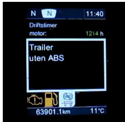
Figur 59: Informasjon på display som indikerer at semitrailereren ikke har ABS-funksjon. Foto: SHT
