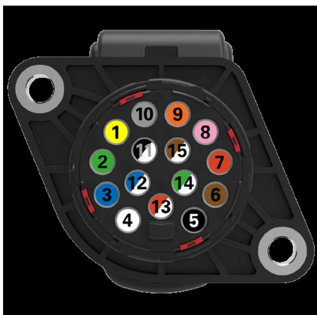
Figur 32: 15-PIN tilkobling. PIN 1,2 og 7 er tilhengerregistrering, PIN 14 og 15 er CAN-bus. Kilde: Erich Jaeger GmbH
