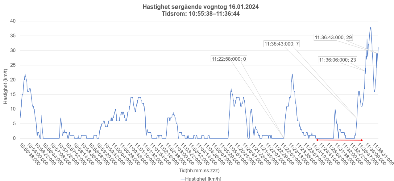
Figur 22: Det sørgående vogntogets fartsskriverdata i tidsrommet da GPS tilsa at lastebilen var inne på området hvor slepvognen ble tilkoblet. Rød strek viser tidsrom med stillstand etter siste «Kraftuttak deaktivert» frem til kl. 11:36:06, som tilsvarer 11,5 minutter. Illustrasjon: SHK
