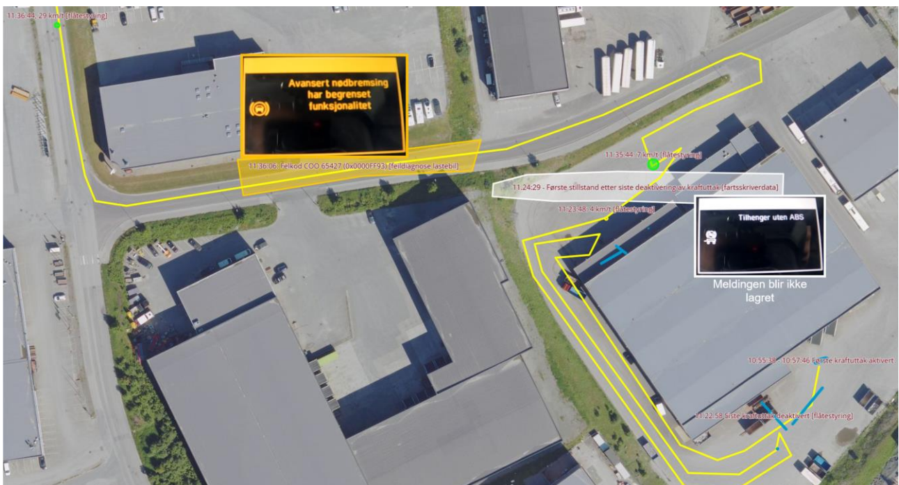
Figur 60: Sannsynlig hvit informasjon synlig på dashboard ved tilkobling av slepvogn tidligst kl. 11:24:29. Sannsynlig gult varsel på dashboard etter oppstart av kjøreturen kl. 11:36:06 (23 km/t). Kart: © norgeskart.no. Illustrasjon: SHK
