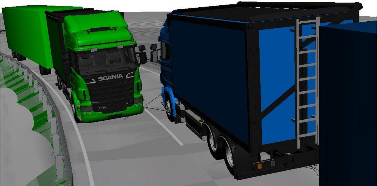
Figur 53: Statisk simulering. Ingen berøring. Klaring mellom speil 0,13 m. Illustrasjon: SHK
