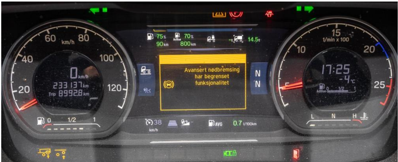
Figur 6: «Avansert nødbremning har begrenset funksjonalitet» på dashbordet, kl. 1725, ca. to timer etter ulykken. Feilmeldingen «Avansert nødbremning har begrenset funksjonalitet» blir nærmere beskrevet i kapittel 1.6.2.5. Foto: Politiet
