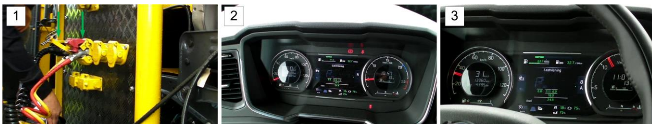
Figur 45: Oppkobling uten bremsetilkobling (1), tenning på (2) og under kjøring opp til 31 km/t (3). Ingen varsler eller synlig tilhenger på dashboard. Totalvekt 24,9 tonn, last bakaksler 18,0 tonn. Foto: SHK
