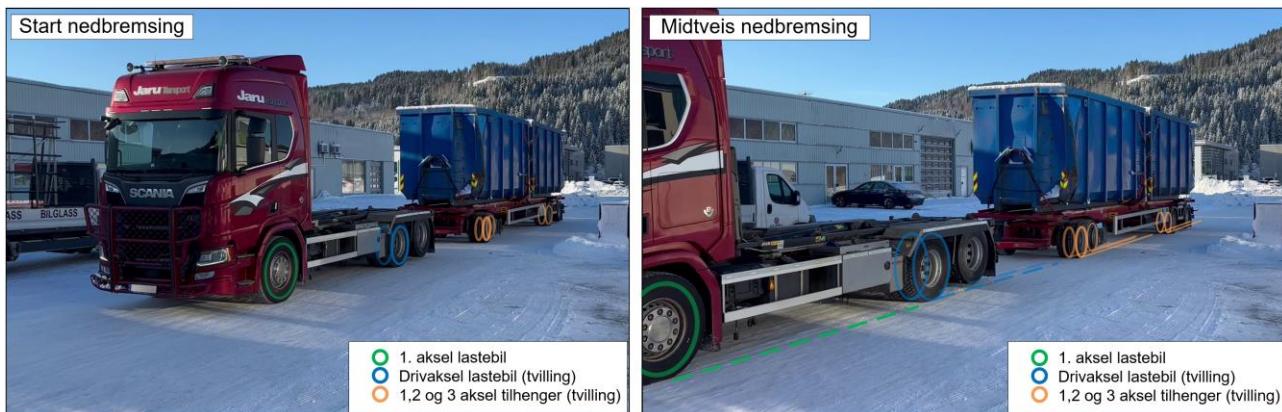
Figur 35: Nedbremsingsforløp. ABS aktiverte på lastebilen, men hjulene låste seg på alle aksler på slepvognen. Foto/illustrasjon: SHK
