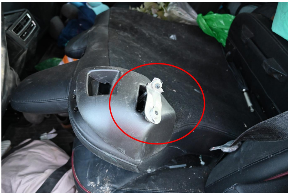
Utrevet innfesting som hang fast i lås til den kollapsede delen av bakseteryggen. Foto: Statens vegvesen
