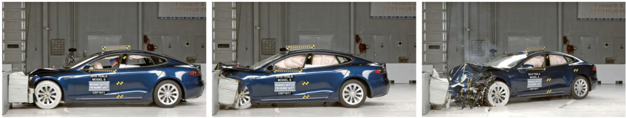
Figur 45: Tesla model S 2016 under kollisjonstest med moderat overlapp i 64,4 km/t. Kilde:IIHS, CEF1611, FLO03_WIDE
