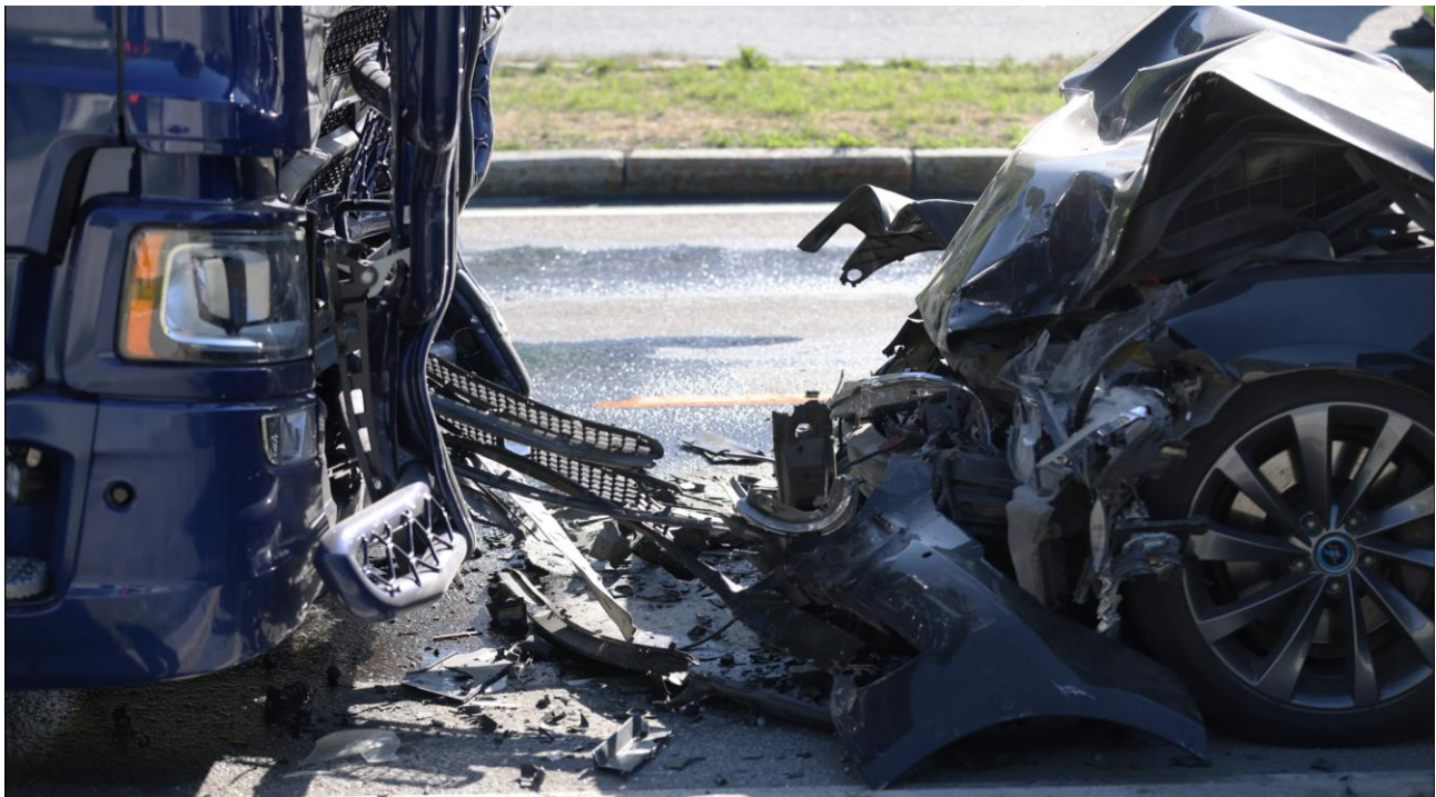
Figur 5: Deformasjoner på trekkbilen og personbilen etter sammenstøtet. Foto: Tangen foto
