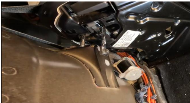
Figur 33: Forsøk #1, vridning rett før skulderbeltet røk ved 1 660 kg. Foto: SHK
