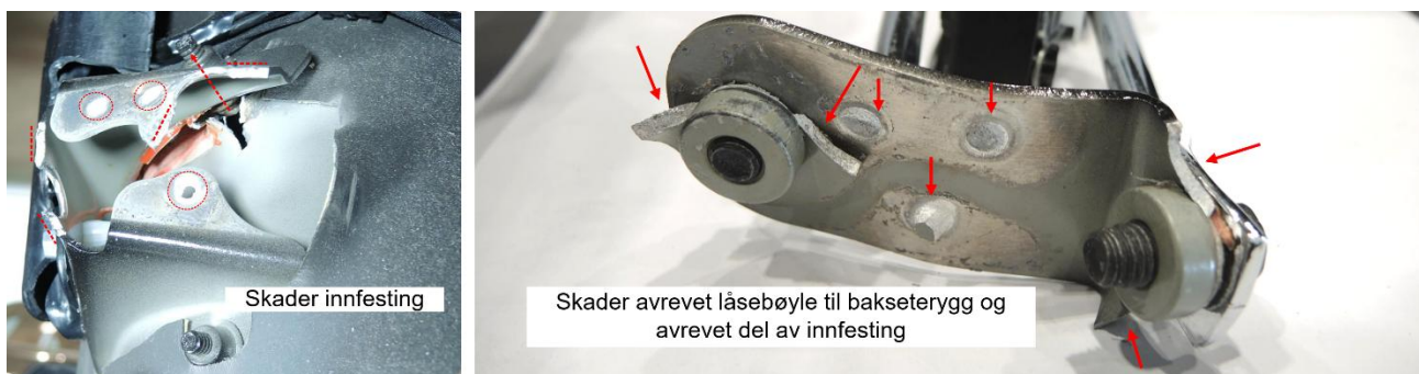
Figur 29: Ulykkesbilens innfesting, utrevet brakett og avrevet låsebøyle. Foto: SHK
