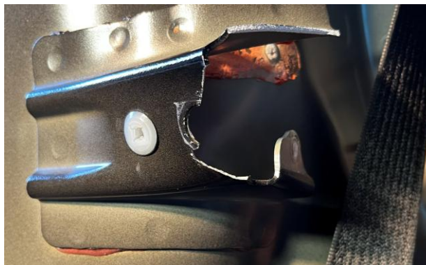
Figur 37: Avrevet innfesting mot hjulbuen. Foto: SHK
