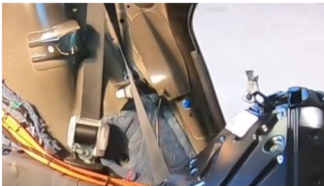
Figur 36: Avrevet innfesting og låsebøyle hengende igjen i bakseteryggen. Foto: SHK
