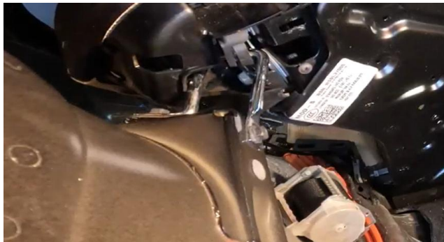
Figur 34: Forsøk #2, vridning og kontakt mellom lås og låsebøyle ved 740 kg. Foto: SHK
