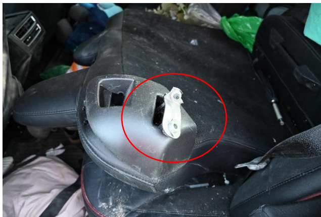
Figur 8: Utrevet innfesting som hang fast i lås til bakseterygg (60-del). Foto: Statens vegvesen
