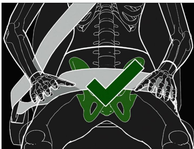
Figur 47: Rett plassering av hoftedelen på bilbeltet. Illustrasjon: SHK
