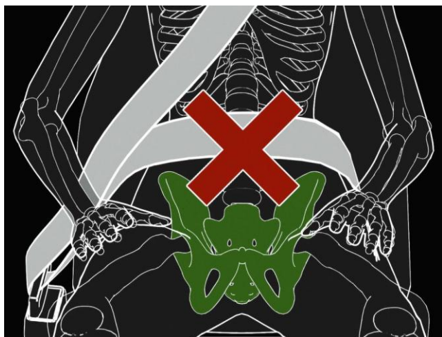
Figur 46: Feil plassering av hoftedelen på bilbeltet. Illustrasjon: SHK
