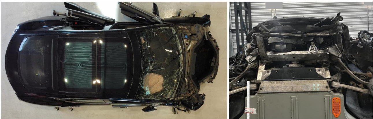
Figur 6: Personbilen etter kollisjonen sett ovenfra og deformasjonssonen i front sett fra undersiden. Foto: SHK
