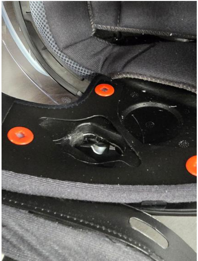
Figur 30: Ødelagt innfesting på hjelmens innside. Foto: SHK
