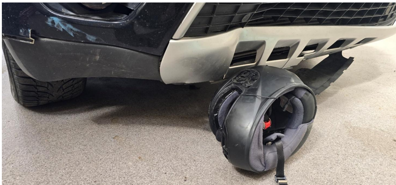
Figur 18: Hjelmens posisjon mot bilens eksteriør med skrapemerker vendt ned mot underlaget. Foto: SHK
