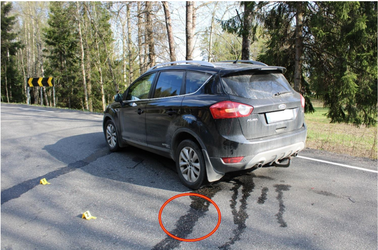
Figur 13: Personbilens sluttposisjon. Kjølevæskelekkasje (rød ring) viser bilens posisjon, før den ble flyttet etter ulykken. Foto: Statens vegvesen. Illustrasjon: SHK
