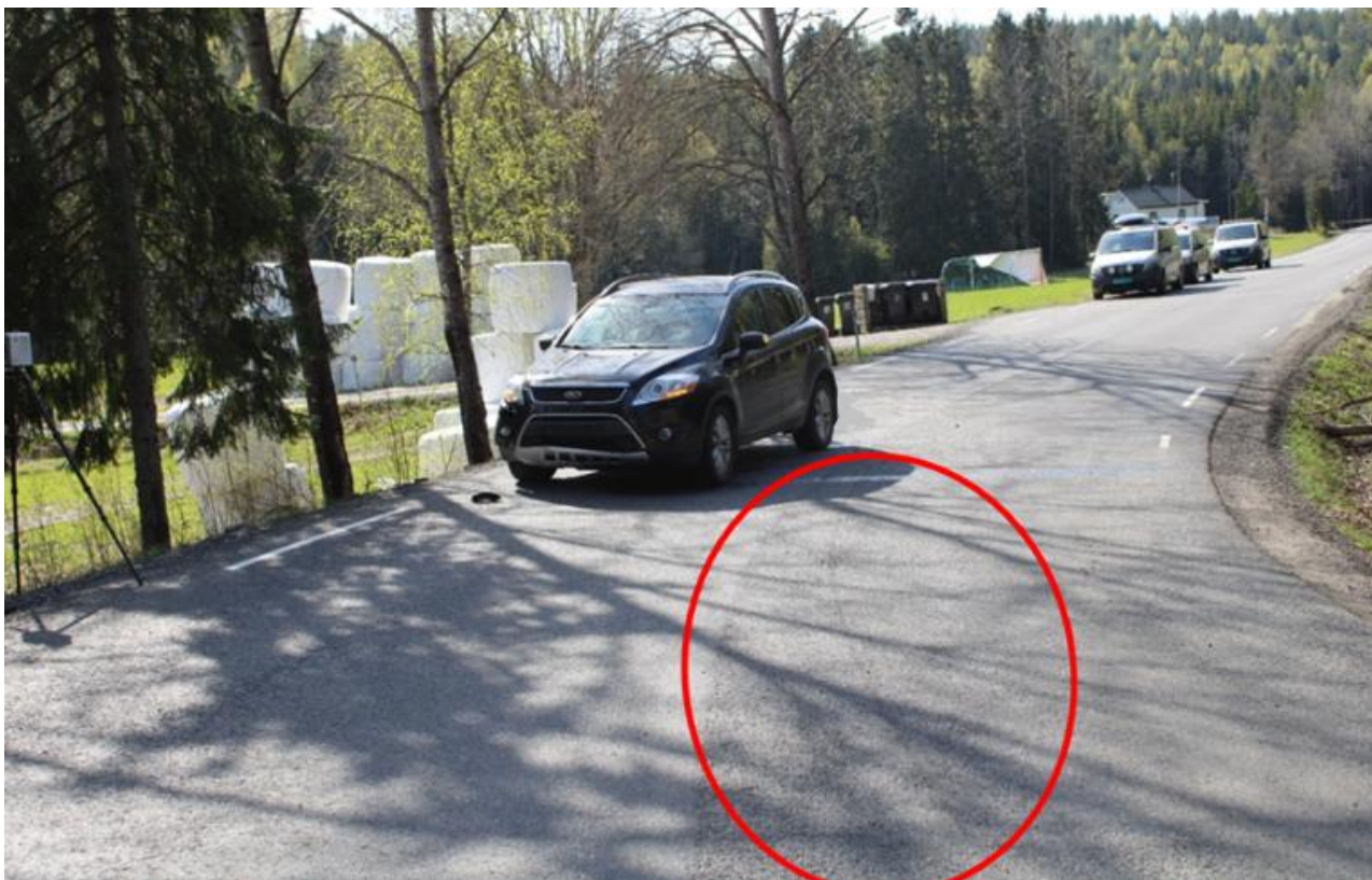
Figur 9: Dekkspor i asfalten inn mot antatt treffpunkt. Foto: Statens vegvesen. Illustrasjon: SHK
