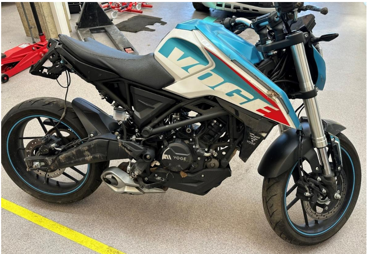
Figur 4: Skader på høyre side og bak på motorsykkelen. Skrapemerker på høyre sidedeksel og svingarm. Foto: SHK
