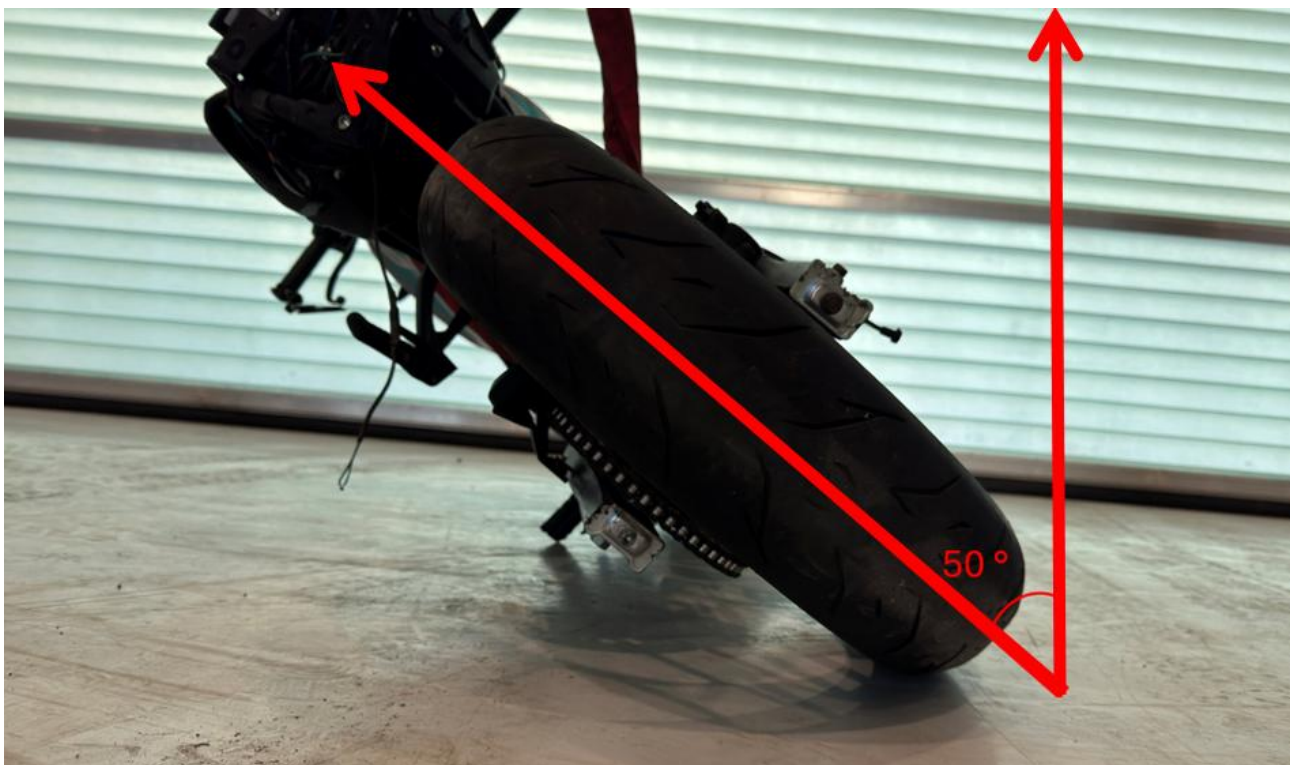
Figur 27: Motorsykkelens maksimale nedleggsvinkel målt fra fotstøtte uten pinne. Foto og illustrasjon: SHK
