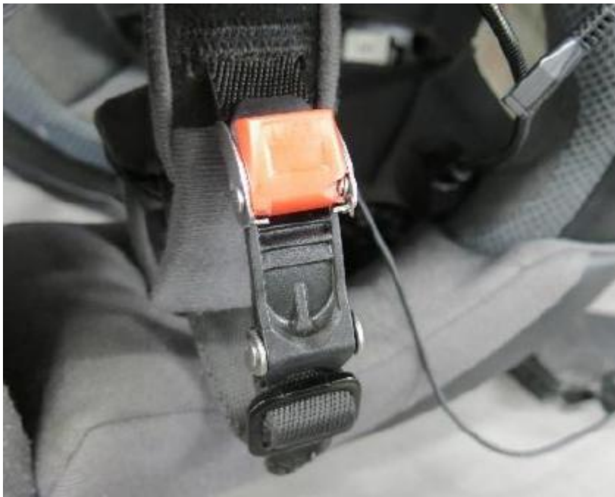
Figur 28: Skadet låsemekanisme (hurtigkobling). Foto: RISE
