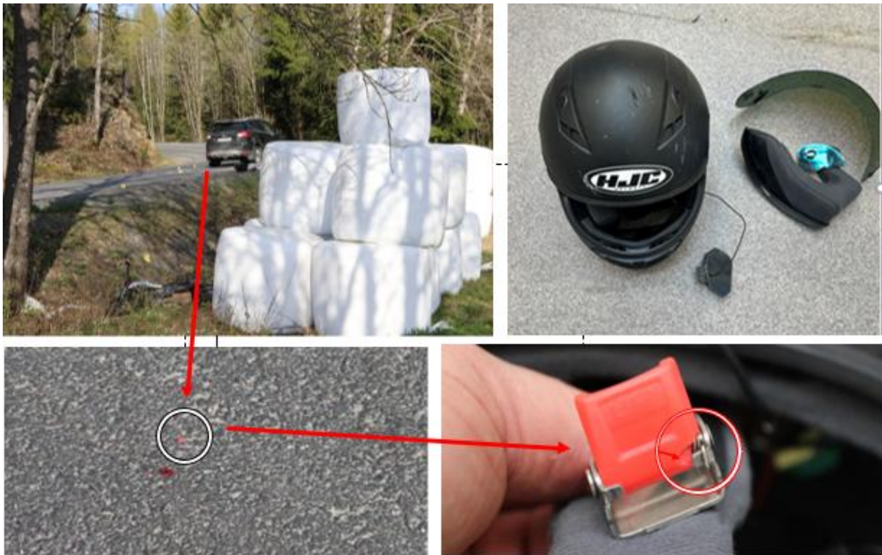
Figur 6: Ulykkesstedet med personbilen og motorsykkelen sluttposisjon øverst til venstre. Bildet nederst til høyre viser skade på låsemekanismen til hjelmens hakestropp hvor det manglet en liten del. Bildet nederst til venstre viser en liten rød fluoriserende plastdel observert på ulykkesstedet rett bak personbilen. Hjelmen etter ulykken øverst til høyre med ødelagt intercom, visir og hjelmens innerfôr. Foto: Politiet og SHK. Illustrasjon: SHK
