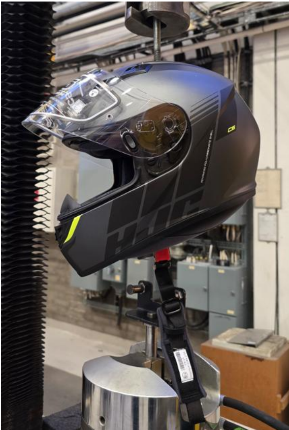
Figur 29: Hjälm i testrigg hos RISE, hakestropp henger ned grunnet ødelagt innfesting. Foto: SHK
