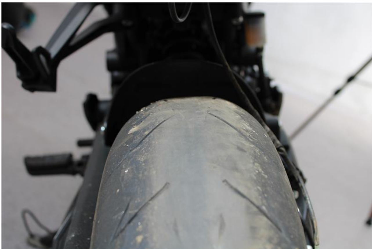
Figur 16: Slitt bakdekk som var flatt på midten. Foto og illustrasjon: SHK
