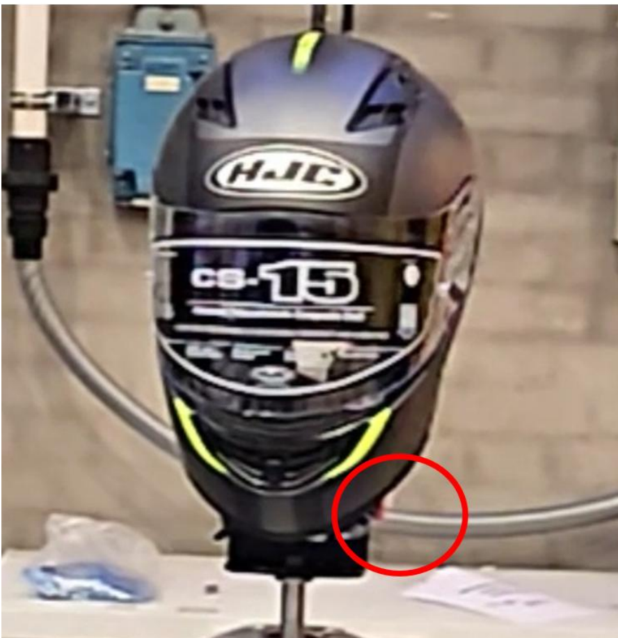
Figur 31: Eksponert låsemekanisme til hakestropp (hurtigkobling) ved strekktest hos RISE. Foto og illustrasjon: SHK
