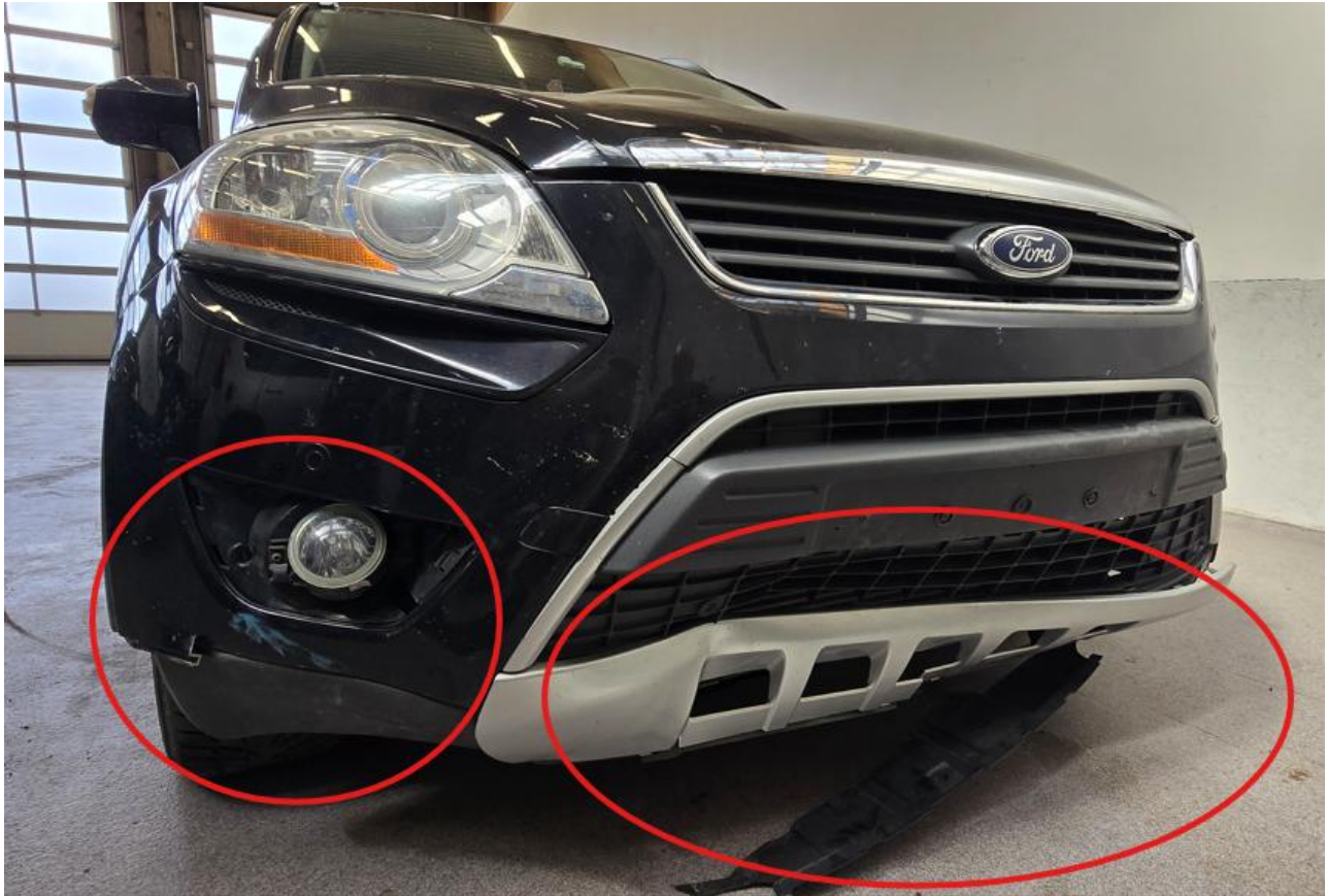
Figur 5: Personbilens skader i front og på høyre side. På personbilens høyre side sees blåfarget avsetning under inntrykket tåkelys som samsvarer med fargen på motorsykkelen. Foto og illustrasjon: SHK
