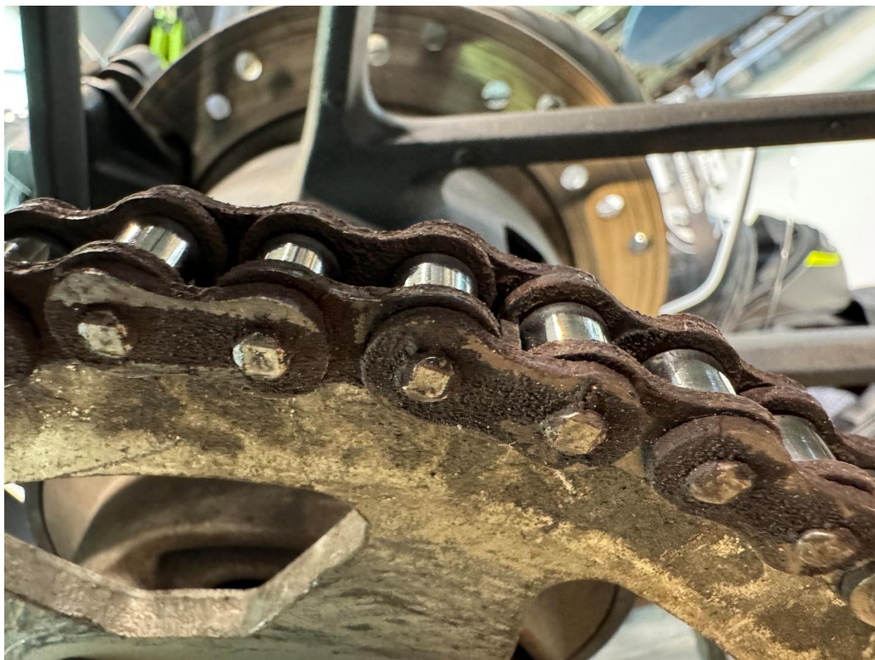
Figur 15: Slitt kjede med lite smøring. Foto: SHK
