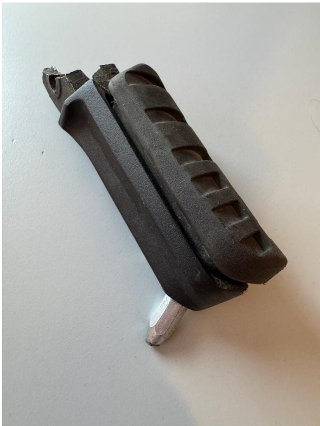
Figur 25: Høyre fotstøtte med pinne som ble ødelagt i ulykken. Foto: SHK
