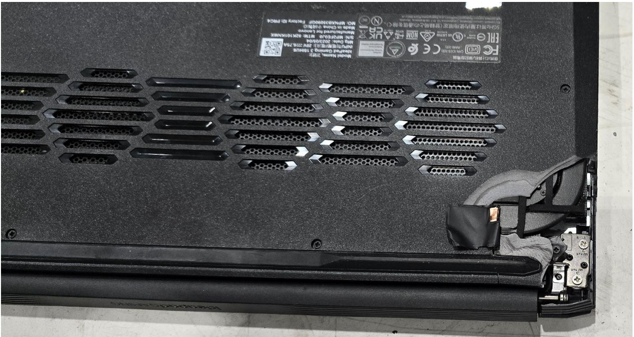
Figur 12: Skade på PC i ryggsekk. Foto: SHK
