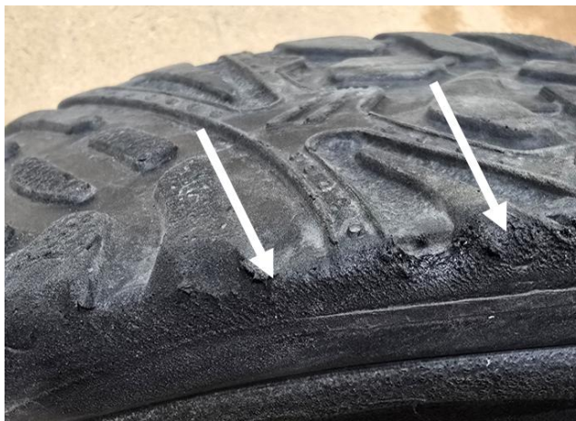
Figur 16: Skrapespor på skoens høyre ytterkant (hvite piler). Foto: SHK
