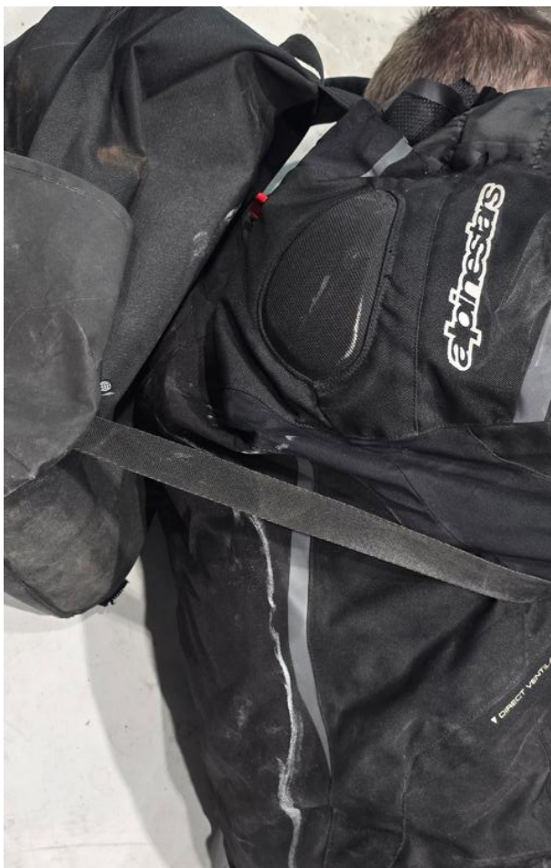
Figur 42: Figuranten ligger på sin venstre side. Ryggbeskytteren dekker et område nede på venstre side av ryggen, og ryggsekken har rom for bevegelse i retning mot figurantens hode. Foto: SHK
