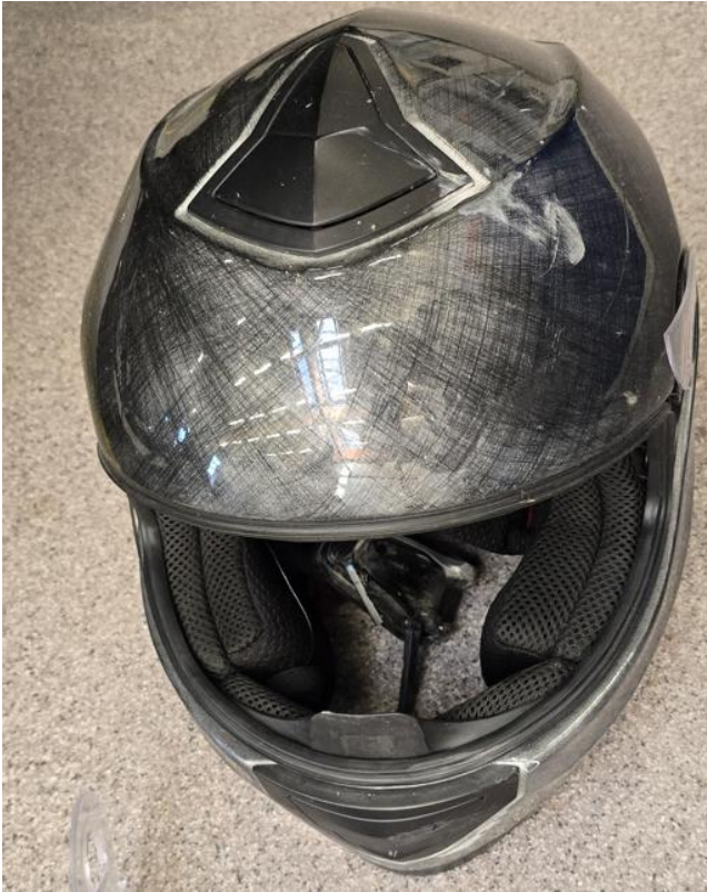
Figur 7: Hjelmen etter ulykken. Skrapemerker øverst på høyre side. Intercom har falt av. Foto: SHK
