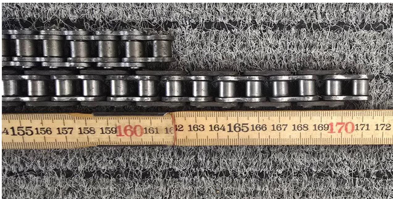
Figur 23: Nytt kjede øverst. Kjede fra ulykkessykkelen nederst. Foto: SHK
