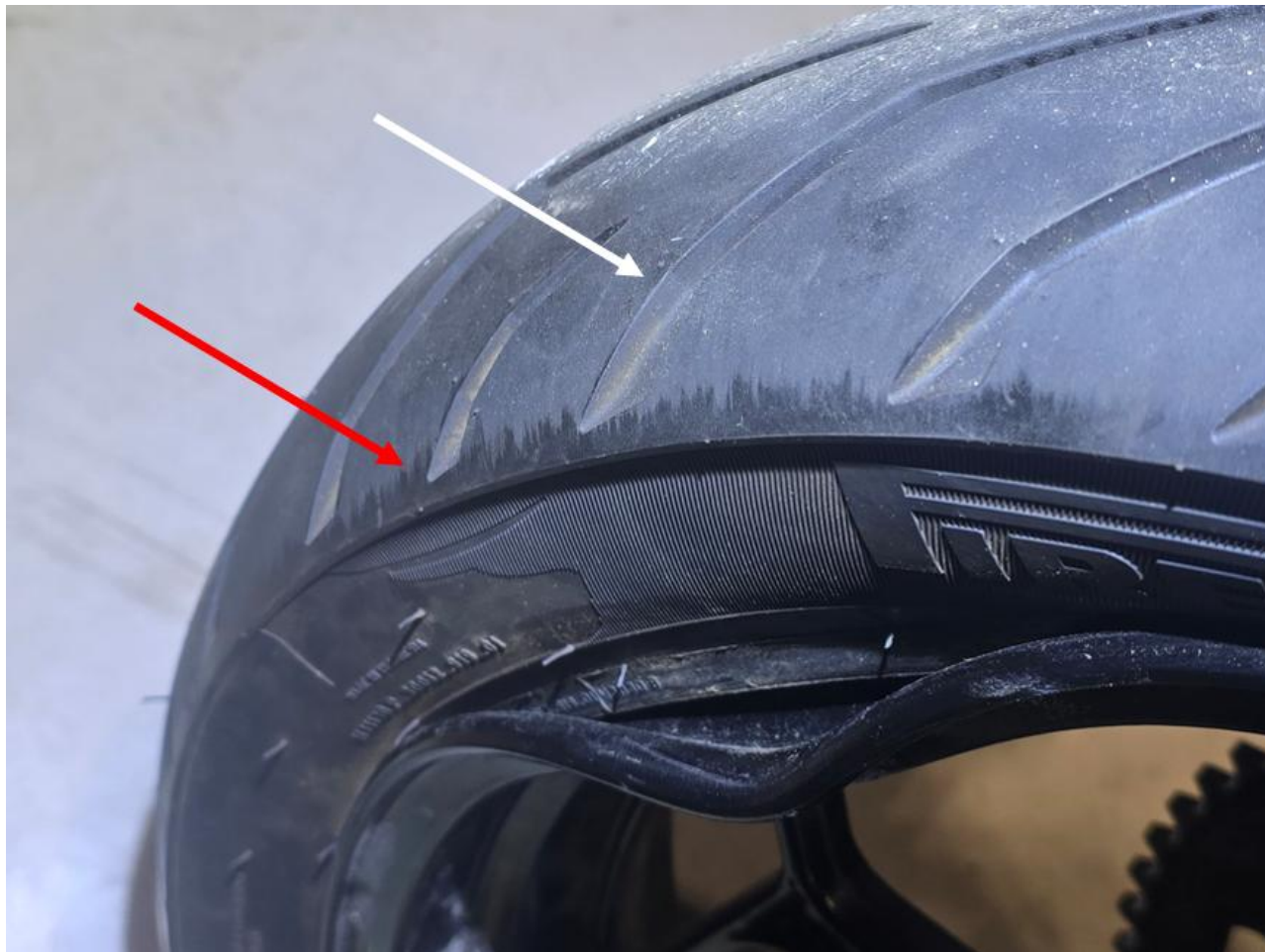
Figur 21: Bakdekket var nylig skiftet og hadde lite slitasje (hvit pil). Ytterkanten av dekket hadde fortsatt en glatt overflate (rød pil). Foto: SHK
