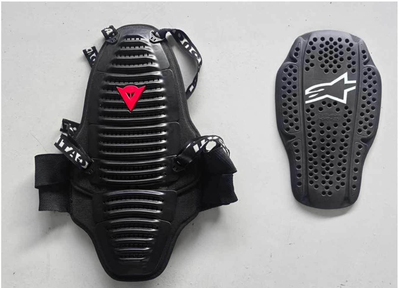
Figur 41: Avstivet ryggbeskytter som festes til føreren med borrelåsbelte og seler til venstre. Myk ryggbeskytter integrert i MC-jakke fra ulykken til høyre. Begge er i størrelse Medium. Foto: SHK
