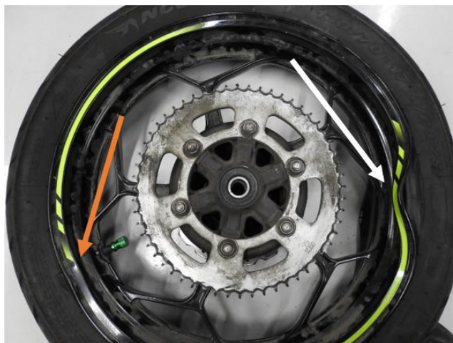
Figur 6: Skader på bakfelg. Bulk på begge sider (hvit pil) og mindre bulk (oransje pil). Foto: SHK
