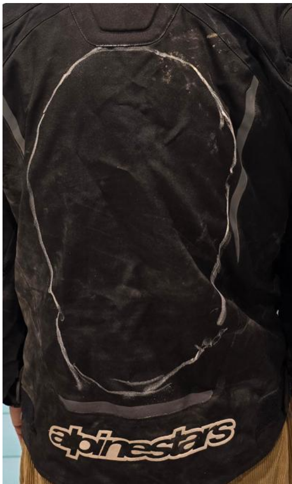
Figur 43: Område som er dekket av ryggbeskytteren er merket med kritt. Foto: SHK
