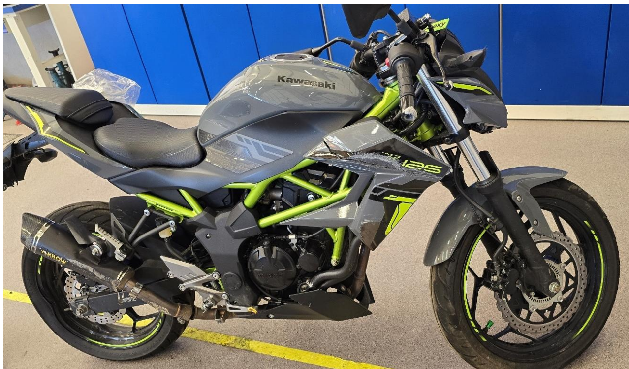
Figur 20: Motorsykkelen slik den så ut etter ulykken, med ettermontert sportseksos. Foto: SHK
