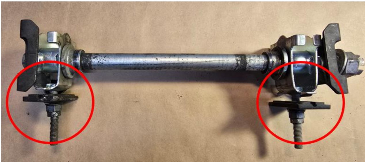
Figur 22: Hjulaksel med kjedestrammere markert med rødt. En større del av gjengene er synlig på høyre side. Foto: SHK
