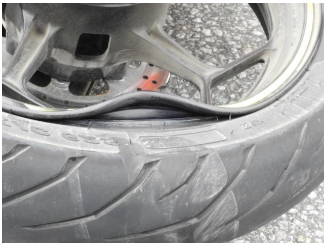
Figur 5: Skader på bakfelg, og merke etter rekkverksstolpen på dekket. Foto: SHK
