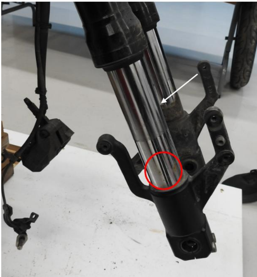
Figur 9: Spor av "svetting" (hvit pil) og ujevnheter (rød sirkel) på nedre del av gaffelbenet. Foto: SHK
