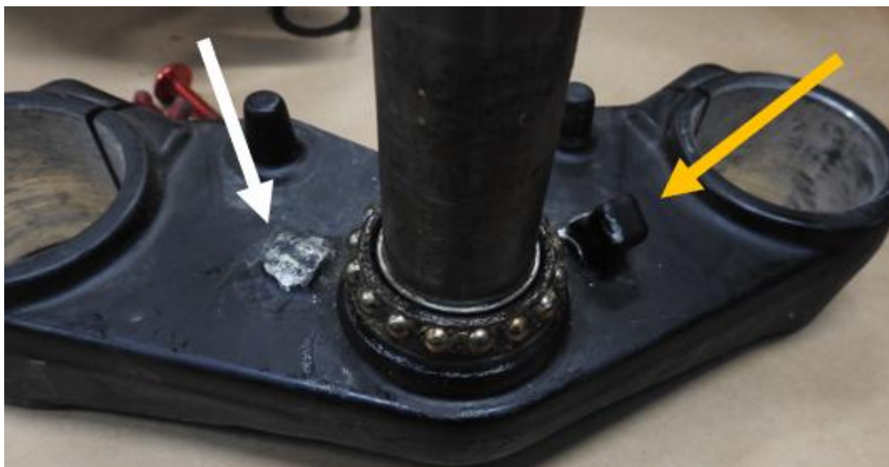
Figur 15: Venstre styrestopper var sveiset og falt av i ulykken (hvit pil). Høyre styrestopper var delvis revet av etter ulykken (oransje pil). Foto: SHK
