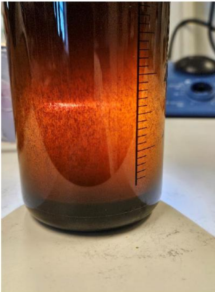
Figur 14: Prøve av støtdemperolje høyre side. Foto: FOLAT
