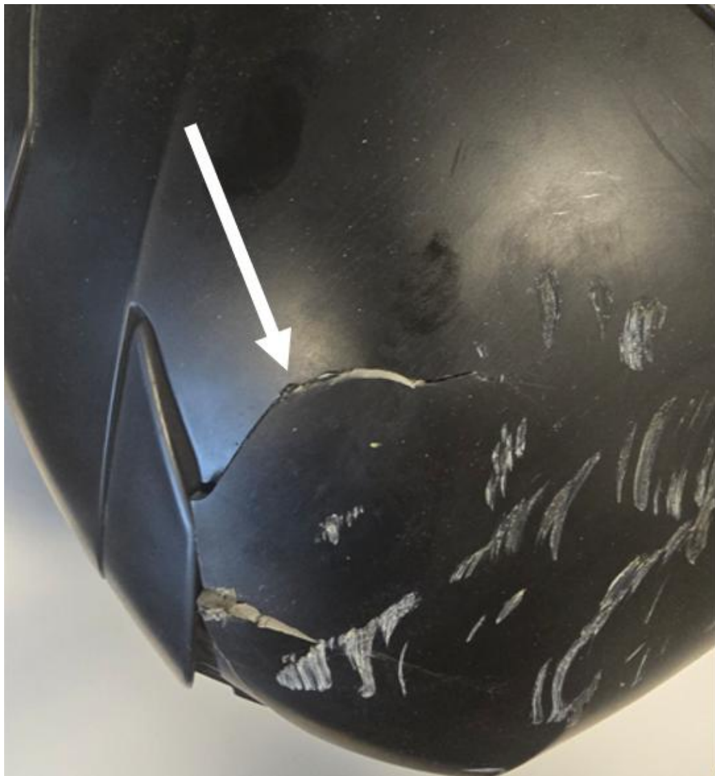
Figur 5: Skader på hjelmen i form av sprekk (hvit pil) og skrapemerker på høyre side bak. Foto og markering: SHK
