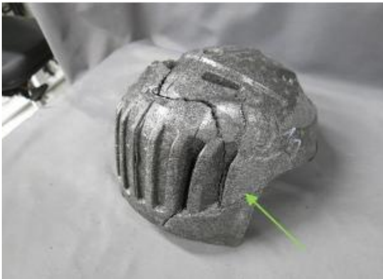
Figur 20: Hjelmens innerskall (EPS) ble tatt ut og undersøkt av RISE. Pilen viser hvor EPS-en er mest komprimert. Sprekken som går på tvers av innerskallet, oppstod ved demontering 13 . Foto og markering: RISE
