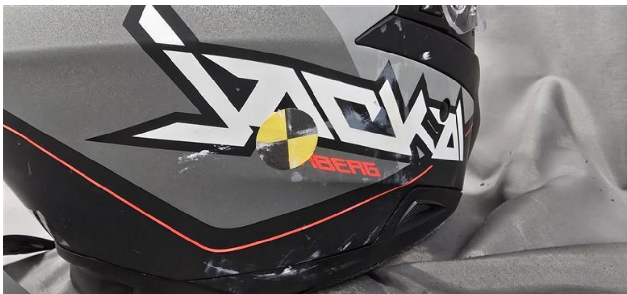
Figur 21: Hvit krittffarge viser omrisset av treffpunktet under test av hjelm nr.1 høyre side, der innpresset i ulykkeshjelmens EPS var størst. Foto: RISE
