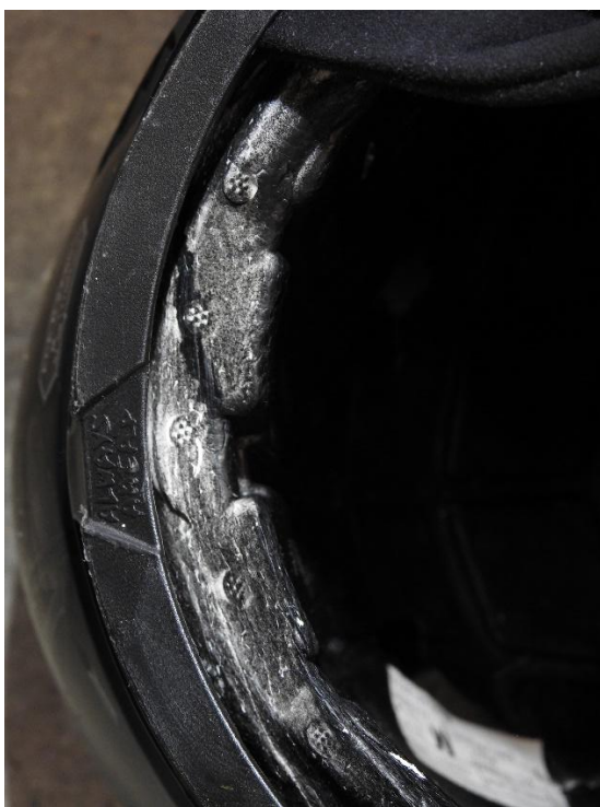
Figur 11: Skader på hjelmen etter ulykken i form av skrapemerker og innpress nederst på bakre beskyttelsesmateriale. Foto: SHK
