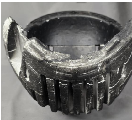
Figur 20: Bakre underkant av hjelmens EPS. Foto: SHK
