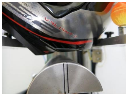
Figur 22: Testambolt og treffpunkt, hjelm 1. Foto: RISE.
