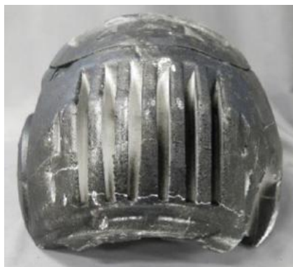
Figur 19: Hjelmens innerskall (EPS) sett bakfra. Foto: RISE
