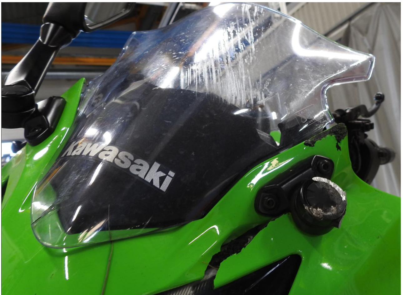
Figur 7: Skader foran på motorsykkelens venstre side. Foto: SHK
