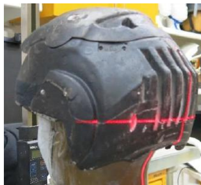
Figur 21: Hjelmens EPS plassert på et testhode. Foto: RISE
