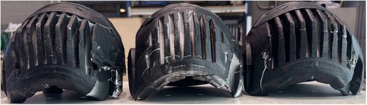
Figur 26: Bakre ytterside av EPS på de ulike hjelmene. EPS fra ulykkeshjelmen i midten. Foto: SHK
