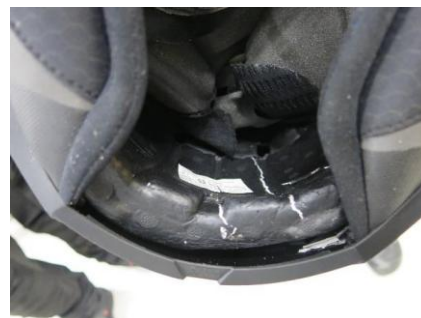
Figur 24: Hjelm 1 EPS under bak, etter test. Foto: RISE.
