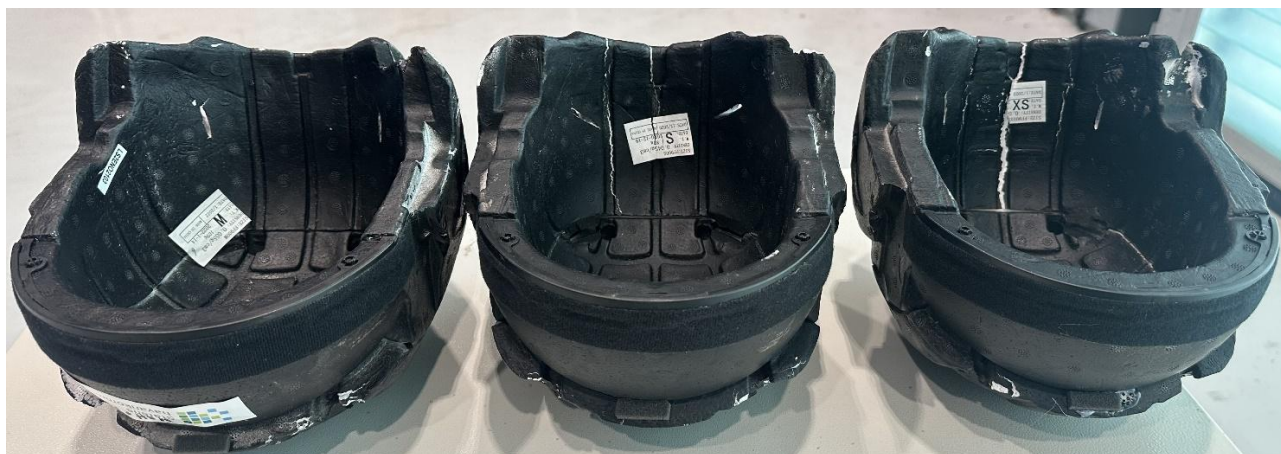
Figur 25: EPS på innsiden bak på ulykkeshjelmene lengst til venstre og de to testhjelmene til høyre. Foto: SHK
