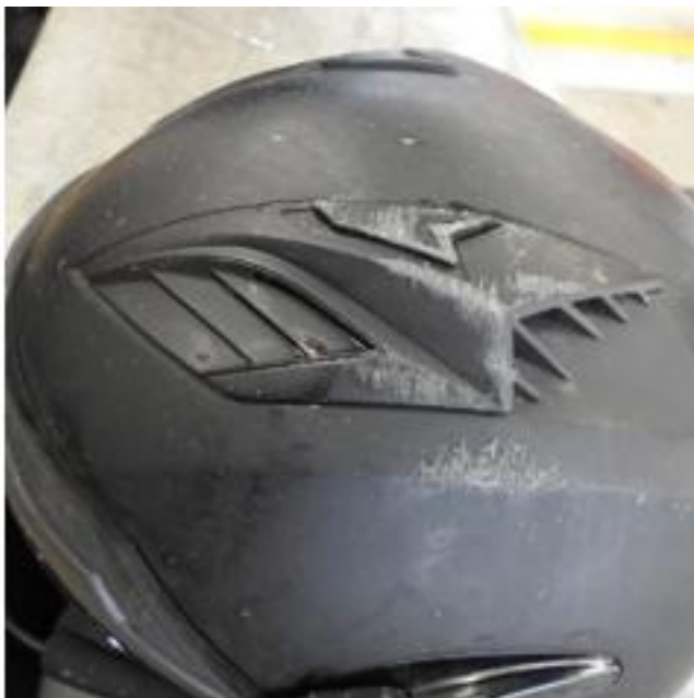
Figur 9: Skrapemerker på venstre side og overside. Foto: SHK
