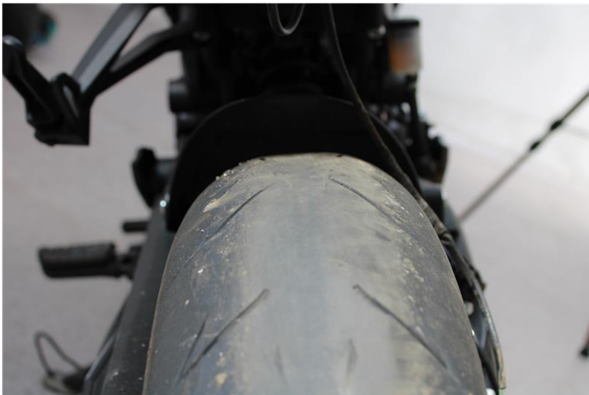
Ikke tilstrekkelig mønsterdybde i dekk. Foto: SHK
