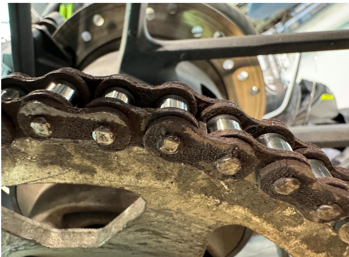
Slitt og dårlig vedlikeholdt kjede. Foto: SHK
