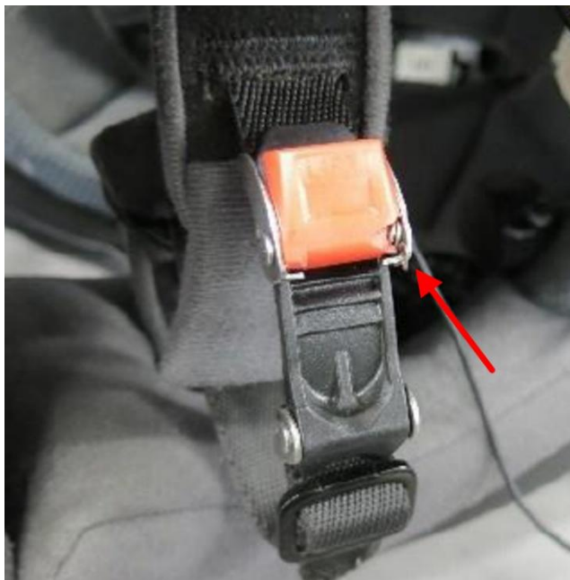
Figur 2: Skadet låsemekanisme (hurtigkobling) på hjelmen til motorsyklisten på fv. 115 i Indre Østfold. Foto: RISE
