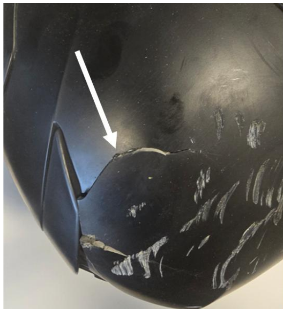
Figur 6: Sprekk (hvit pil) i hjelmen til motorsyklisten på E10 i Tjeldsund. Foto og markering: SHK
