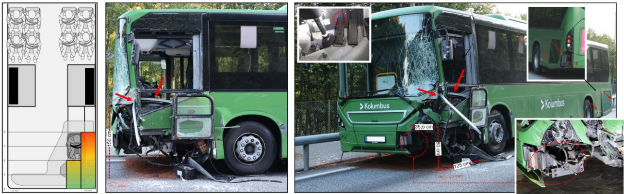
Figur 14: Kjøretøyskader illustrert til venstre. Bilder av fastklemt bremsepedal, området rundt bussens venstre frontbjelke og skaper bakover langs bussens venstreside. Foto: Statens vegvesen. Markering og illustrasjon: SHK
