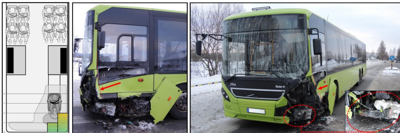
Figur 20: Kjøretøyskader illustrert til venstre. Bøyd frontbjelke og utvridning av venstre sidevegg er markert. Foto, markering og illustrasjon: SHK
