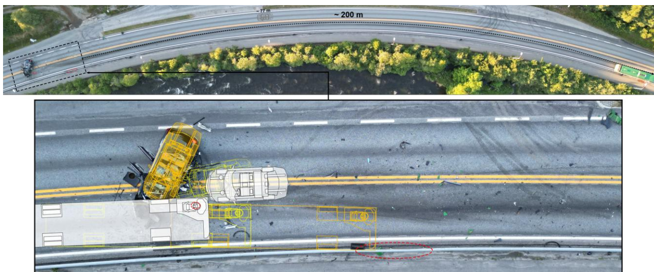
Figur 13: Oversikt over ulykkesstedet, antatt kollisjonspunkt og kjøretøyenes bevegelse rett etter kollisjonen. Foto: Statens vegvesen. Illustrasjon: SHK
