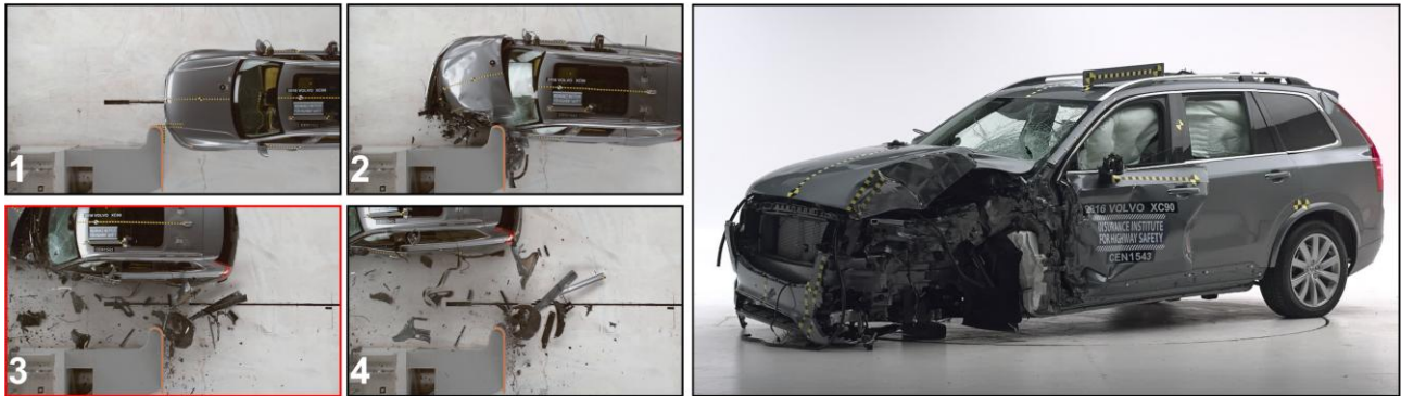
Figur 18: Test av 2016 Volvo XC90 ( CEN1543 ) Small Overlap Front Test, sekvens 1–4 og skader etter test. Kilde: IIHS
