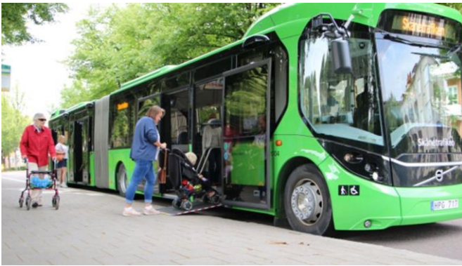
Figur 26: Volvo konseptbuss 2016. Midtstilt førerplass og fremste passasjerinngang bak fremaksel. Foto: Volvo buss
