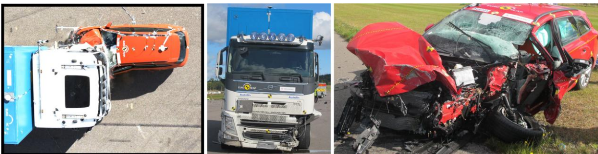
Figur 28: Kollisjonsforsøk og kjøretøyskader med stiv front på lastebil. Begge kjøretøyene hadde en kollisjonshastighet på 50 km/t mot hverandre i testene. Foto: Trafikverket/Chalmers
