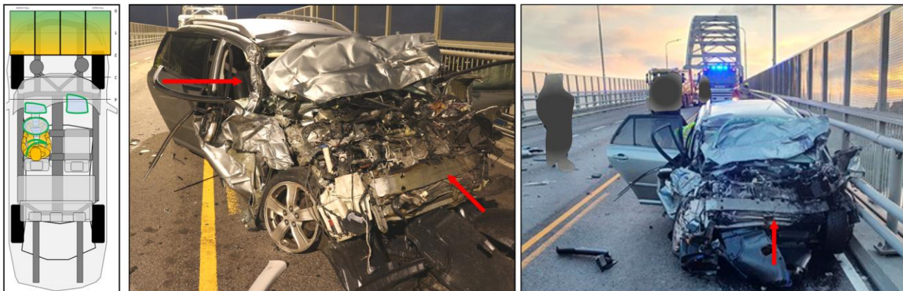
Figur 12: Kjøretøyskader og aktivert sikkerhetsutstyr illustrert til venstre. Piler viser kontaktpunkt med buss. Foto: Politiet og Statens vegvesen. Markering og illustrasjon: SHK
