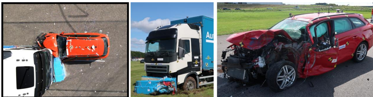
Figur 29: Kollisjonsforsøk og kjøretøyskader med en energiabsorberende front i form av en solid plate installert på lastebil. Begge kjøretøyene hadde en kollisjonshastighet på 50 km/t mot hverandre i testene. Foto: Trafikverket/Chalmers
