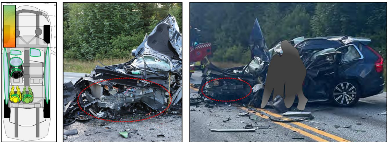
Figur 15: Kjøretøyskader og aktivert sikkerhetsutstyr illustrert til venstre. Personbilens venstre framhjul var revet av, men det var lite skader på venstre rammevang. Foto: Statens vegvesen og politiet. Markering og illustrasjon: SHK
