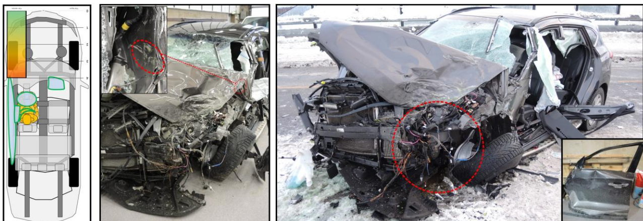
Figur 21: Kjøretøyskader og aktivert sikkerhetsutstyr illustrert til venstre. Spor av grønn maling på innsiden av A-stolpe, og mindre skader på venstre rammevang. Foto, markering og illustrasjon: SHK
