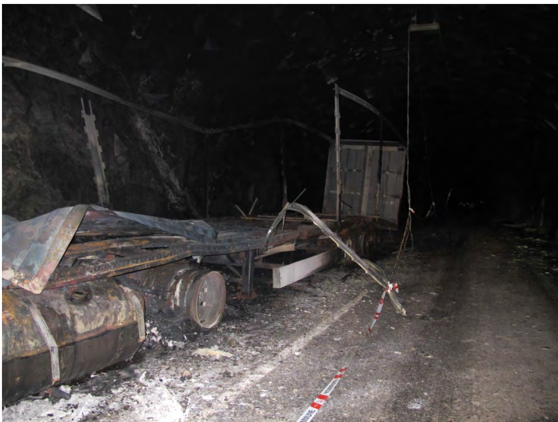
Figur 2-3 Bildet viser den utbrente semitraileren. Foto: SHT.
