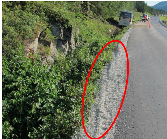
Figur 9: Bussen i sluttposisjon og avsatte spor etter bakre venstre hjulpar i veigrøft (rød ring). Til venstre i bildet vises også fjellskjæringen som bussen unngikk. Foto: SHT
