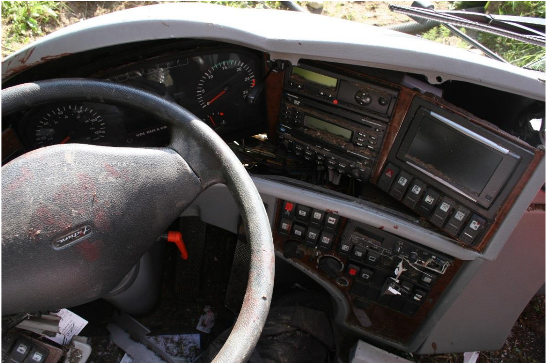
Figur 10: Førermiljøet i bussen. Skjermen til høyre hadde GPS- og ryggekamerafunksjon. Foto: Politiet
