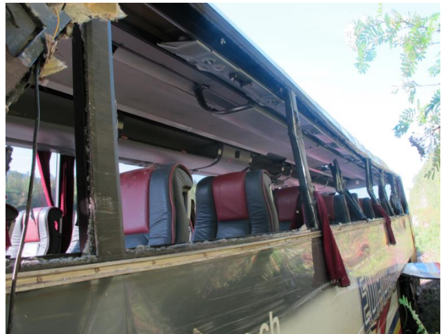
Figur 5: Skader langs bussens venstre side. Foto: SHT
