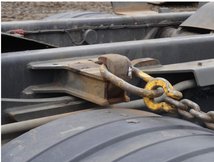
Foto 24. Belastning av låsklack för att mäta den kraft då klacken släpper
