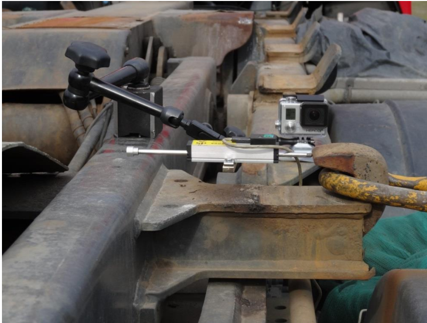
Foto 25. Lägesgivare för mätning av högra låsklackens rörelse då denna belastas i sidled.
