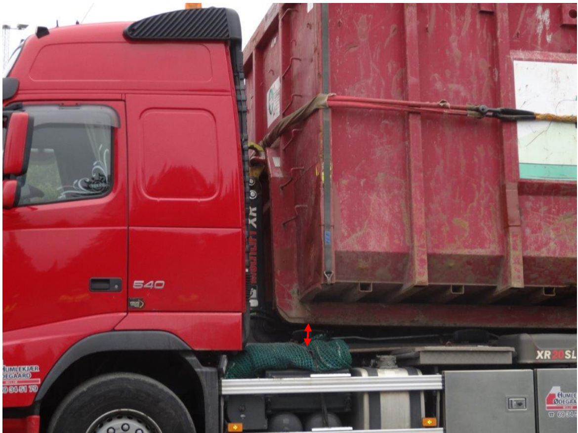
Figur 16: Krokcontainer på lastebil som løfter seg ca. 12 cm (se rød pil) i fremkant ved sidebelastning på ca. 0,5 G. Foto: SP
