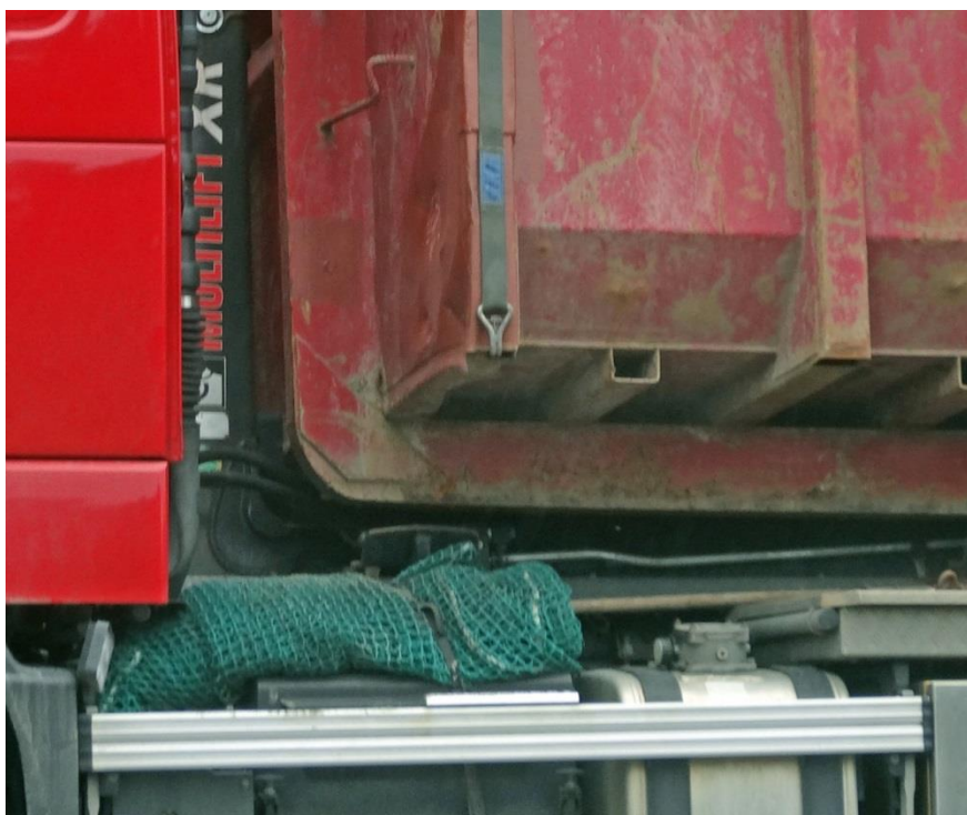
Foto 19. Detalj av föregående foto, avståndet mellan lastbärare och rullflak uppskattades till ca 120 mm i framkant.
