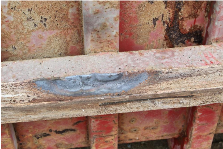
Foto 32. Spår från tidigare reparationer på släpets rullflak
