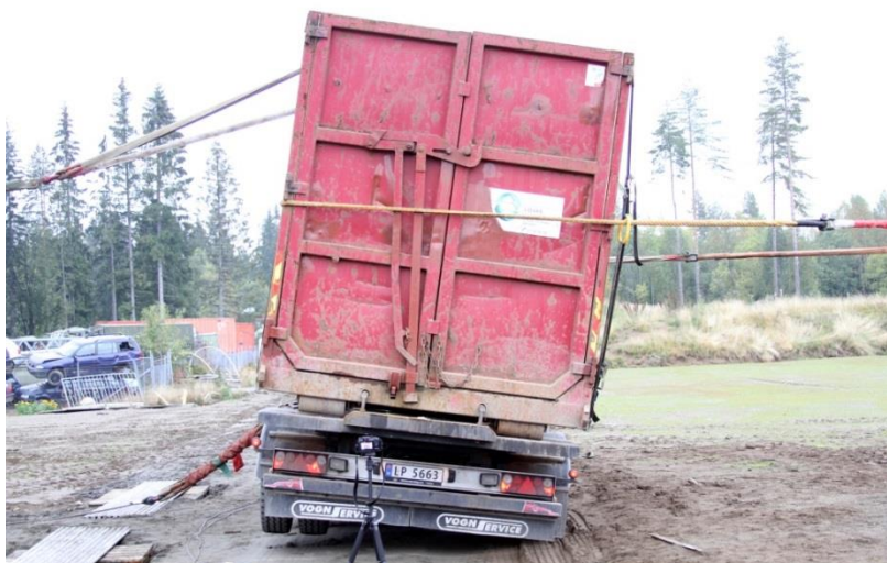
Foto 20. Släpets bakhjul släppte kontakten med underlaget vid lastnivån svarande mot 0,38g.
