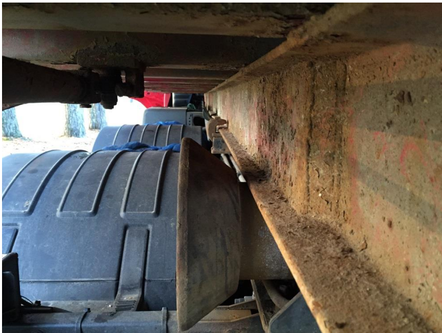
Foto 4. Dragbilens lastplan med de bakre rullarna som stöttar i sidled
