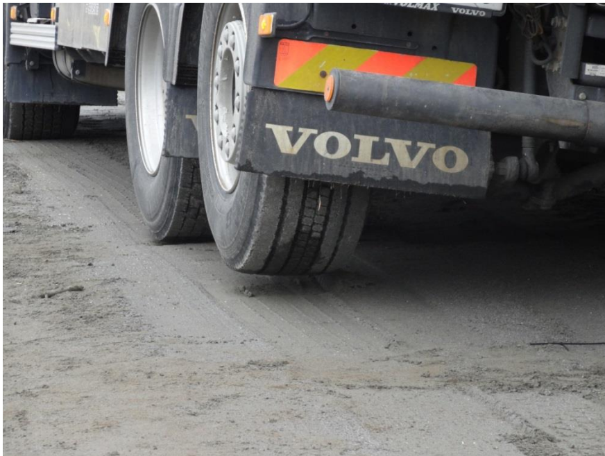
Foto 16. Vid lastnivån motsvarande 0,5g släppte dragbilens bakre hjul kontakten med underlaget.
