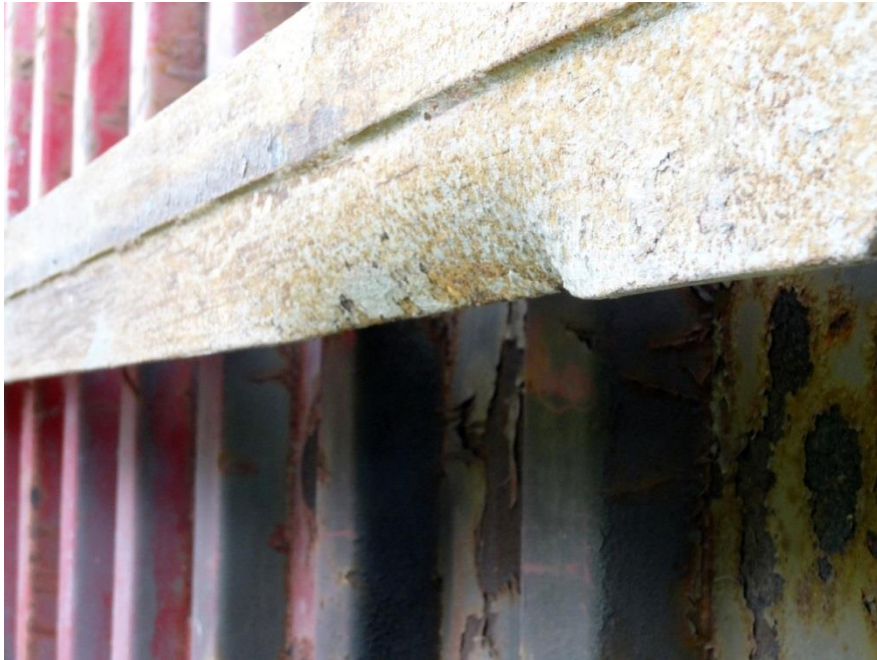
Foto 28. Skada på innerflänsen, dragbilens rullflak
