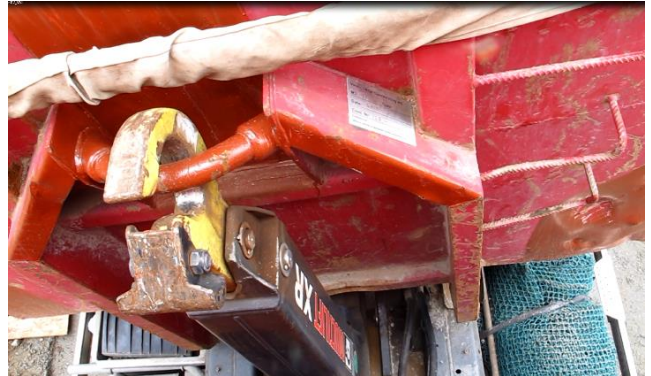
Figur 18: Krokarm og løftebøyle med ca. 0,5 G sideveisbelastning. Foto: SHT
