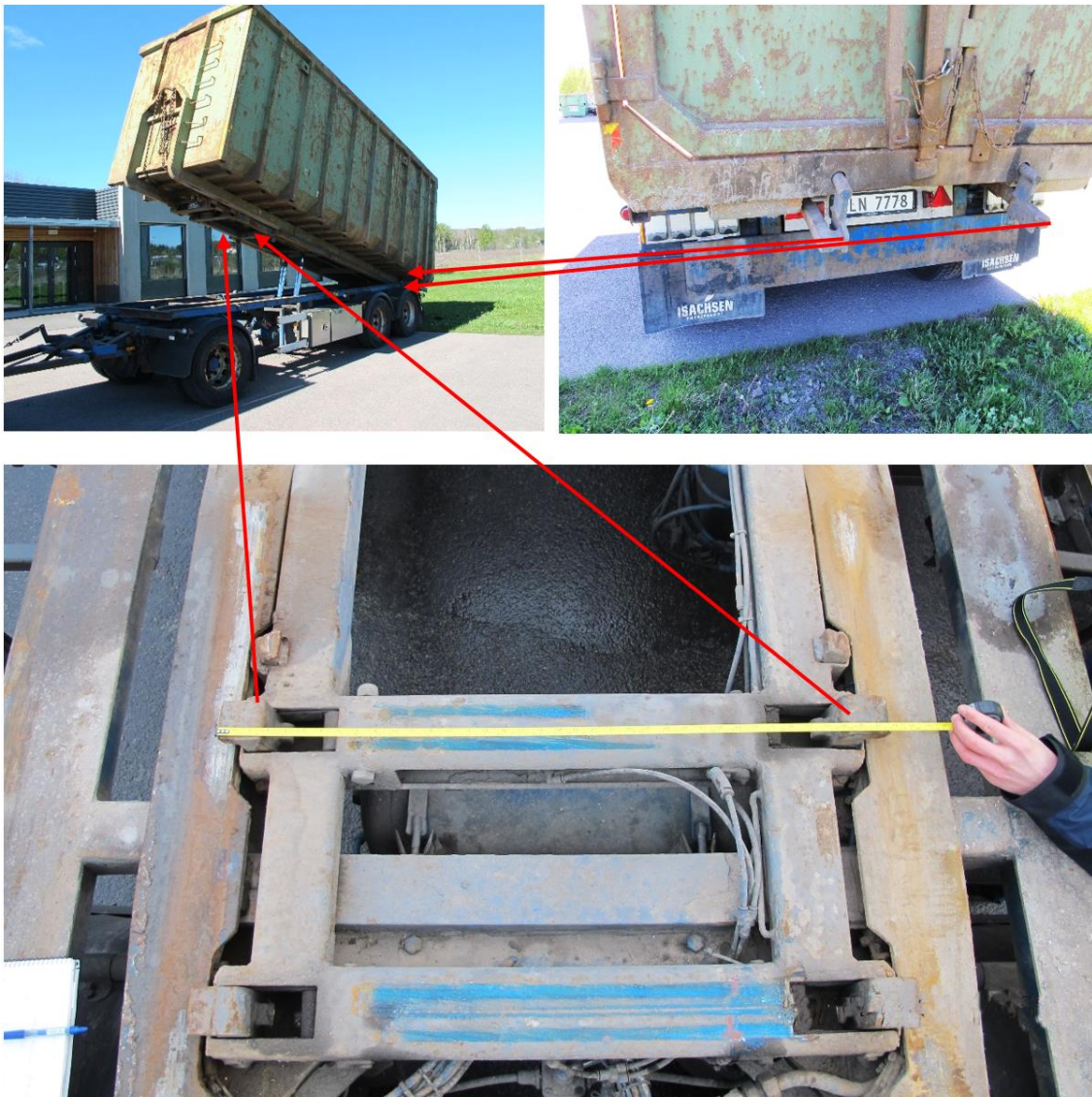
Figur 3: Innfestningene på containeren; fire luftopererte låseklaffer innvendig i front og to låsepiggar bak. De bakre låseklaffer passet med utsparing i containeren på ulykkestidspunktet. Det øvre venstre bildet viser iverksatte tiltak hvor kjetting er brukt mellom container og tippramme. Foto: SHT
