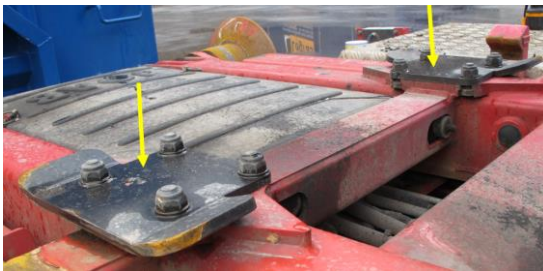
Figur 13: Ettermonterte plater (sort farge, gule piler) som gir innvendig mekanisk låsing i bakkant av container til bilen. I tilfellet på bildet er platene montert på et JOAB krokkløftpåbygg. Foto: SHT
