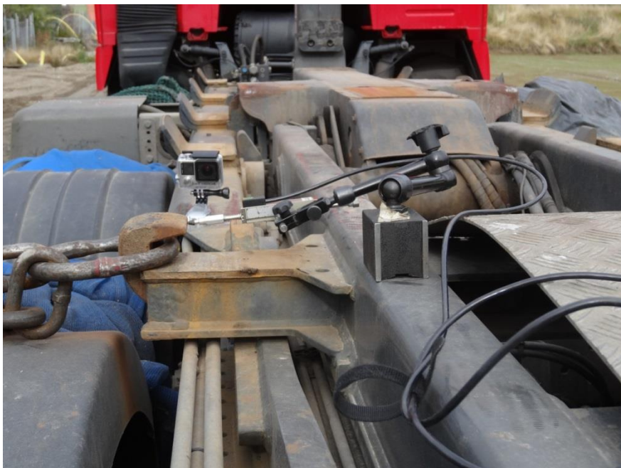
Foto 26. Lägesgivare för mätning av vänstra låsklackens rörelse då denna belastas i sidled
