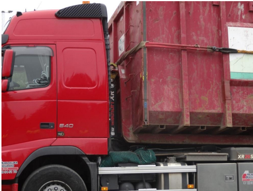
Foto 18. Fotografi vid lastnivå svarande mot 0,5g. Rullflakets främre del har ingen kontakt med dragbilens lastplan.
