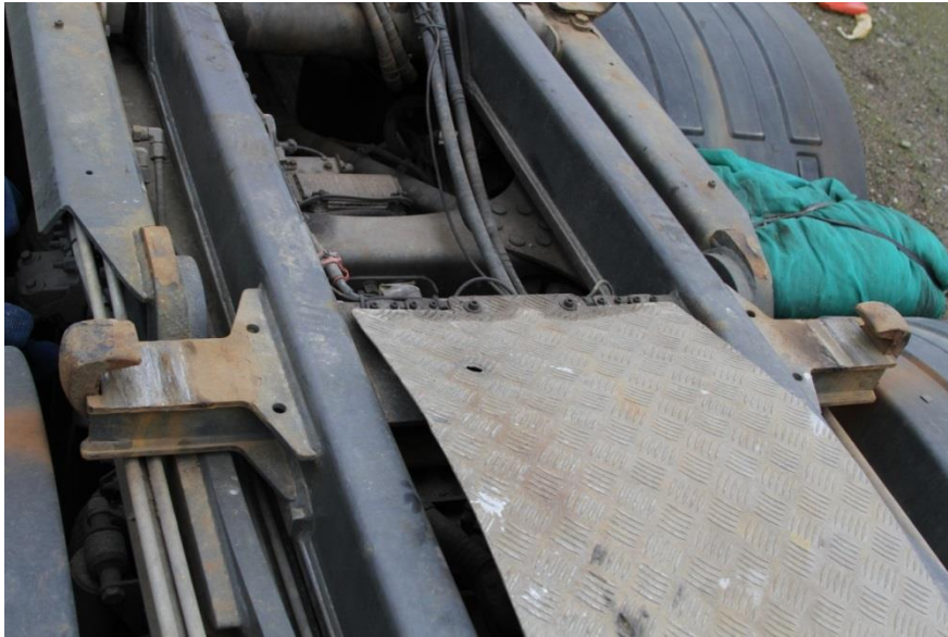
Foto 5. De två utvändiga låsklackarna i dragbilens bakre del
