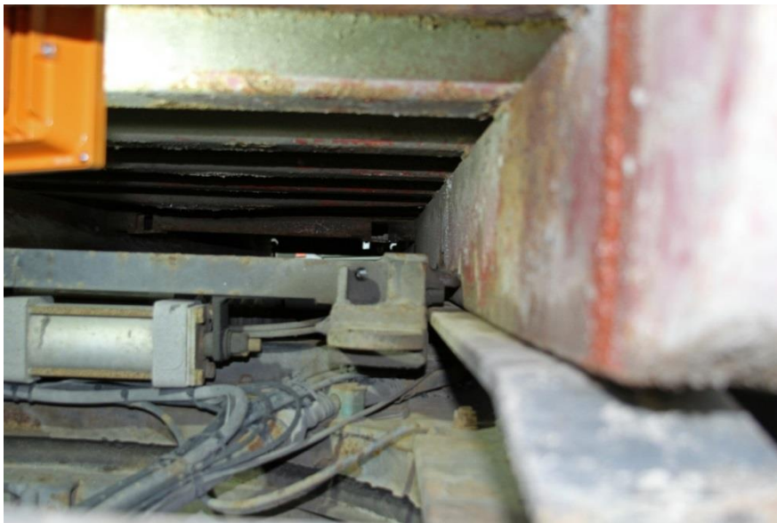
Foto 10. Släp med rullflak, observera att det främre låsklacksparet inte har ett motsvarande fack i rullflaket att greppa i. Det bakre paret låser i ett fack uttaget i rullflakets underdel.
