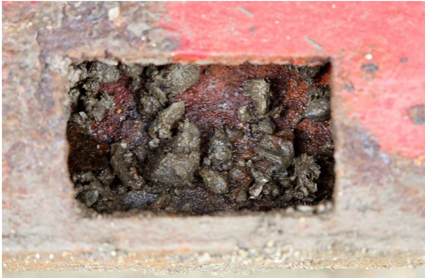
Foto 11. Urtaget i släpvagnsrullflakets underdel i vilket låsklackarna passade, i hålet fanns småsten och grus.
