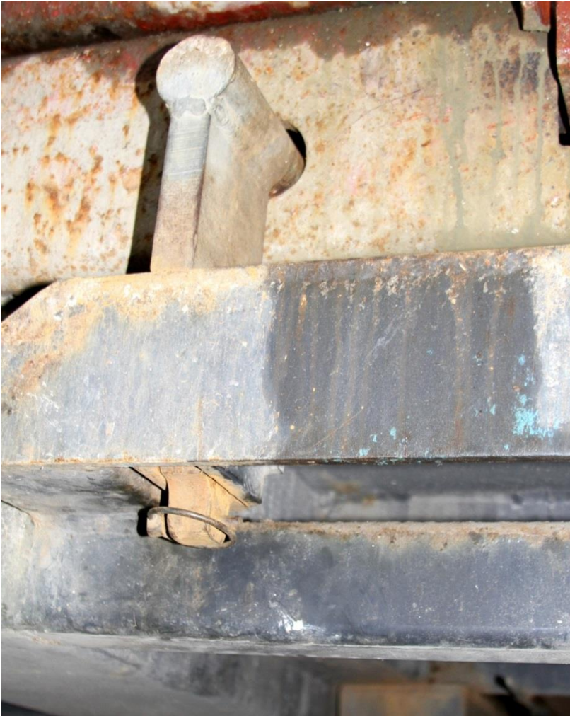
Foto 14. De bakre fästena hålls på plats av en pinnbult som förhindrar att fästet kan lyftas ur sin infästning. Pinnbulten är i sin tur säkrad med en bygel.
