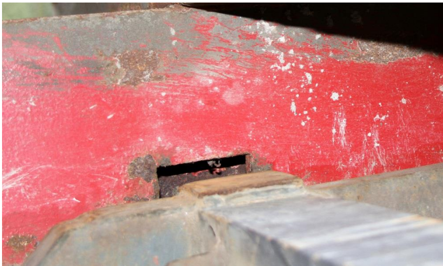
Foto 12. Den bakre av de två främre låsklackarna var i ingrepp i lyftramen
