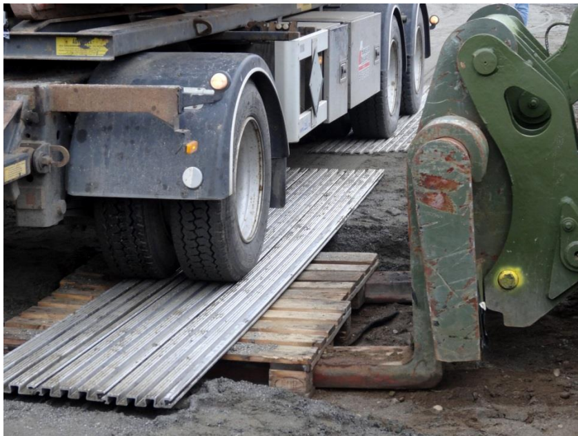
Foto 23. Lyftning av släpets vänstra framhjul för att simulera sväng över förhöjning av vägbanan mellan två körfält.
