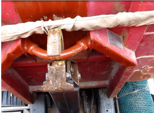
Figur 17: Krokarm og løftebøyle på container uten sideveisbelastning. Foto: SHT
