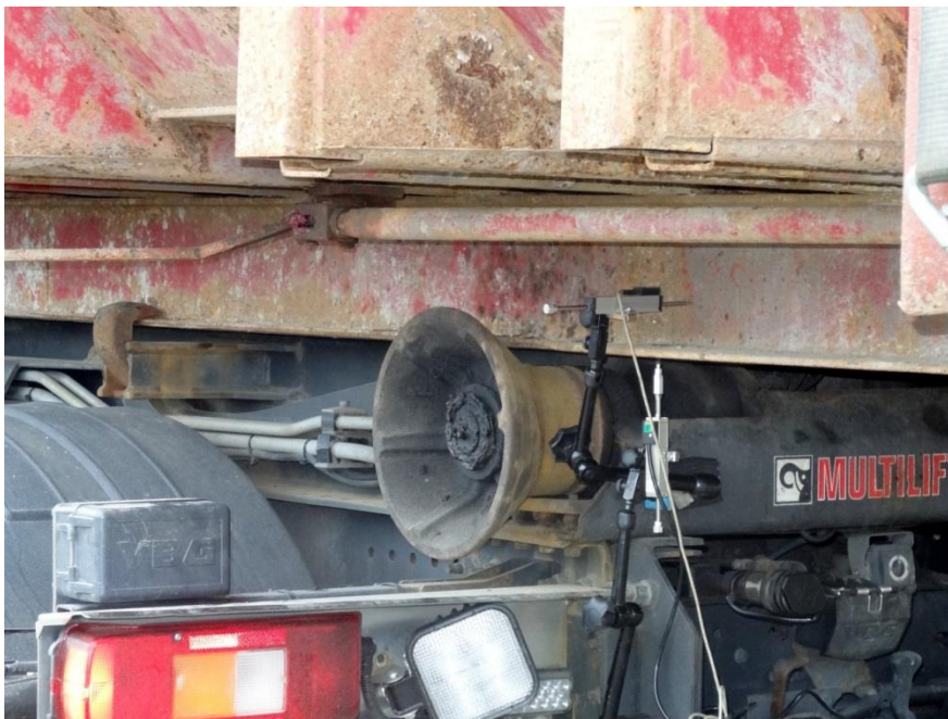
Foto 6. Lägesgivarnas placering vid uppmätning av rörelser i horisontell och vertikal ledd mellan lastplan och rullflak.
