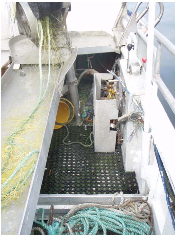
Figur 6: Den blå wiren langs styrbord rekke er en fast installert nødstop. Denne er ikke å anse som selvaktiverende iht. forskriften.
