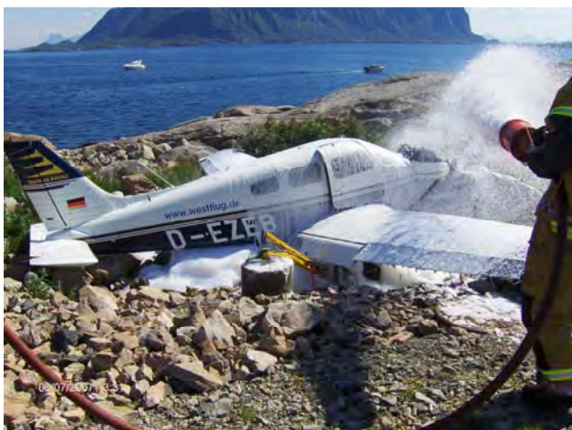
Figur 3: Skumlegging av D-EZEB, havaristedet, brukket innflygingslys og daværende ujevnheter i forlengelse av rullebanen. (Foto: Avinor)
