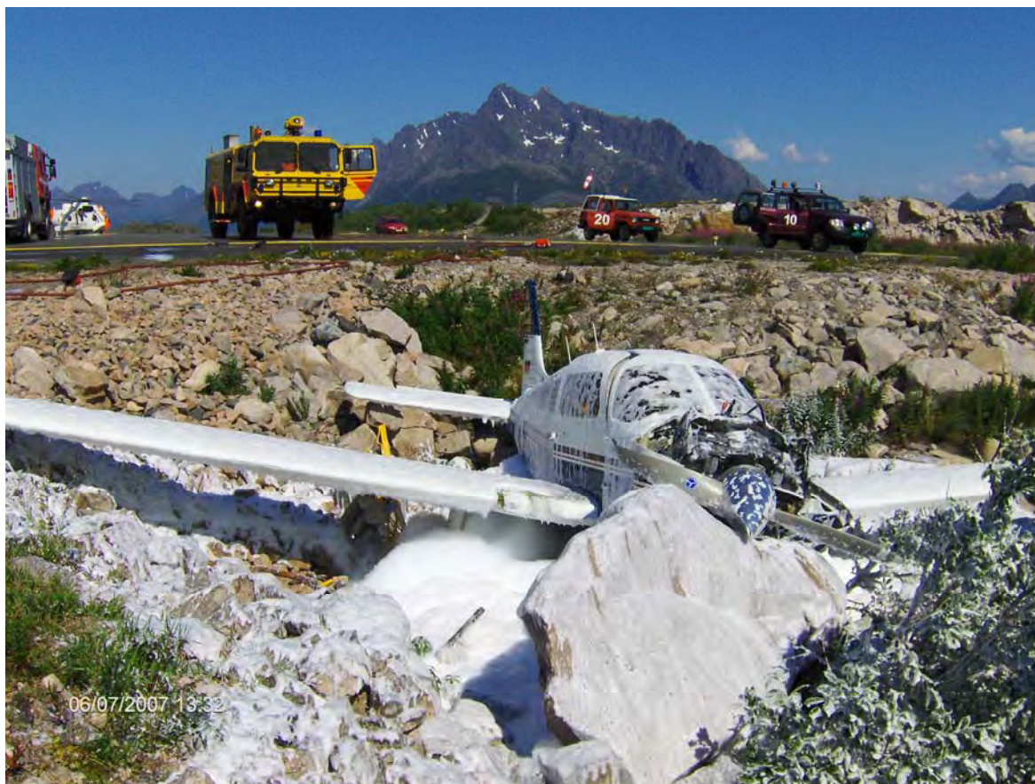
Figur 1: Vrakets posisjon i forhold til rullebanen og daværende ujevnheter i forlengelse av banen. (Foto: Avinor)
