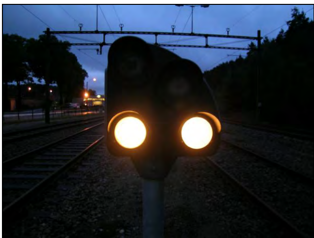
Figur 08: Signalbilde "skifting forbudt" som dvergsignal R 14 viste.
