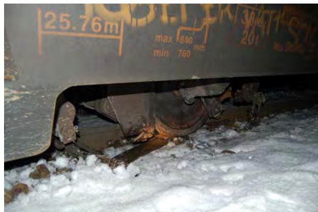
Figur 2: Viser hvor fjæren har falt av.
