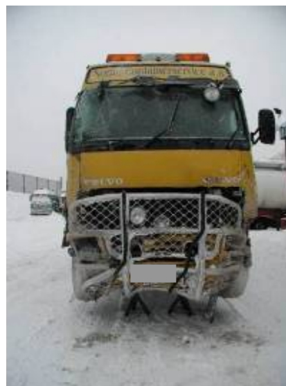
Figur 8: Skader i front på lastebil Volvo FH16 (foto: Statens vegvesen).
