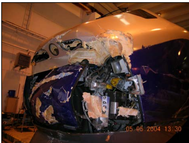
Bilde nr. 4: Skadene i togets front
