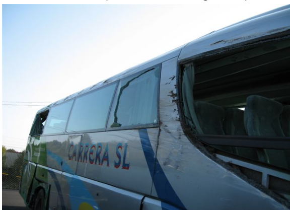
Figur 4: Skader langs bussens høyre side. (foto: Statens vegvesen).
