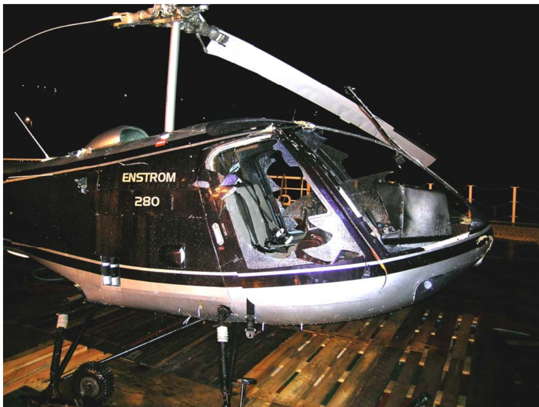
Figur 4: Helikopteret fotografert om natten etter at det var hevet. Frontvinduene og vinduene i begge dørene er knust. Videre kan sees skaden i fronten og bøyingen av hovedrotorbladene.
