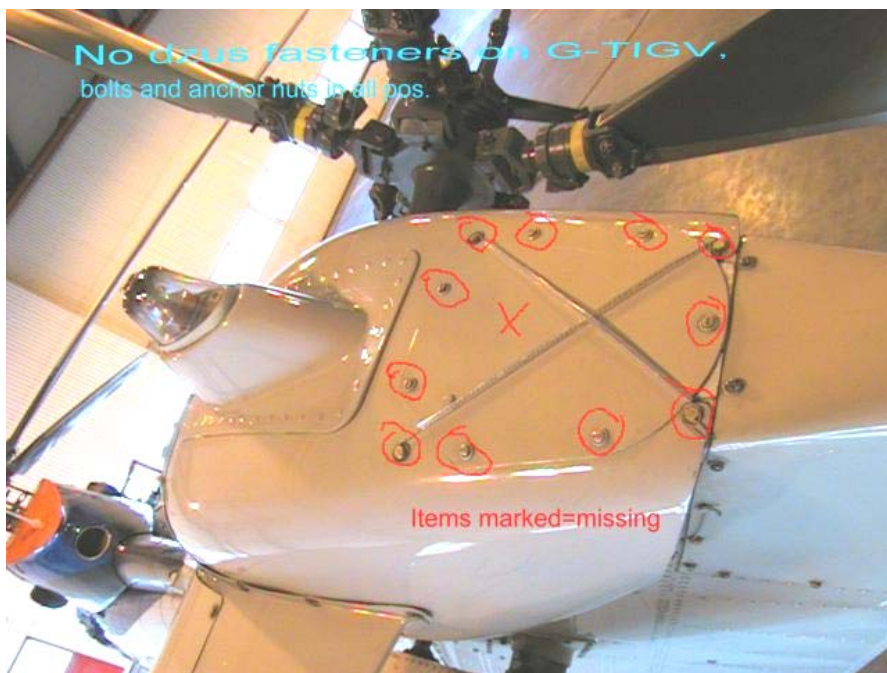
Fig. 2 Illustrasjonsfoto som viser dekslet som falt av og hvilke bolter som manglet etter landing
