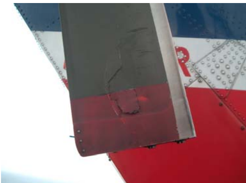
Fig. 1a Skadet halerotorblad etter landing
