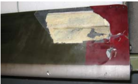
Fig. 1b Skade på baksiden av samme halerotorblad
