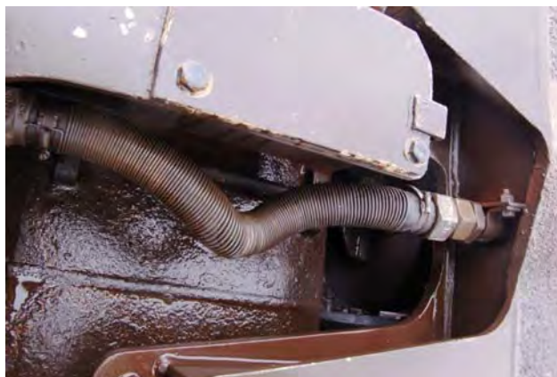
Figur 2: Bremseslangen på vogn 33684955117-9 var montert med vridning.
