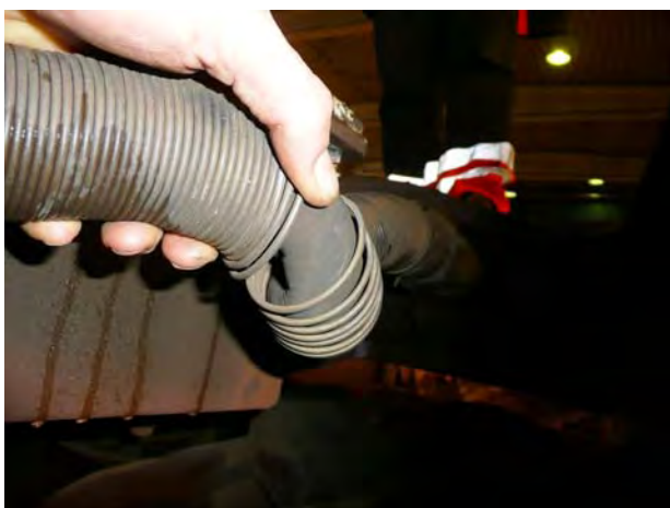
Figur 3: Vridningen av bremseslangen førte til innsnevring av bremseslangen.
