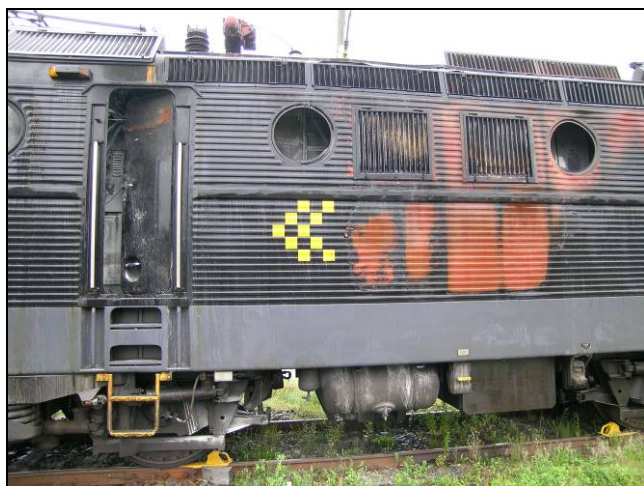
Figur 2 Utvendige brannskader på lokomotiv 16.2216
