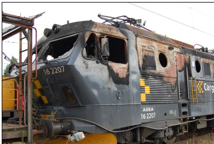
Figur 4 Lokomotiv EI 16.2207 som brant i Sverige ble helt utbrent innvendig, og fikk omfattende skader utvendig.
