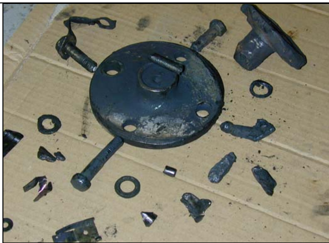
Bilde 2 Skadde deler fra akselkasse.
