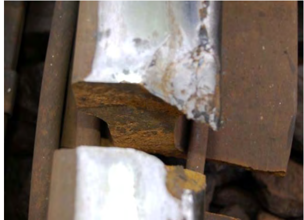
Figur 4: Nærbilde av bruddet i sporvekseltungen.
