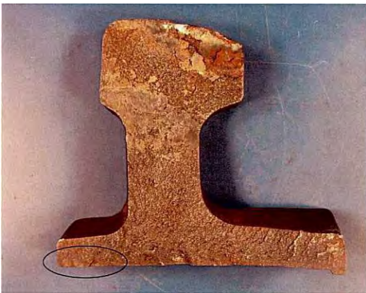
Figur 7 Makrobilde av bruddflaten. Ellipsen markere området med utmattingsbrudd. Foto: Teknologisk Institutt.
