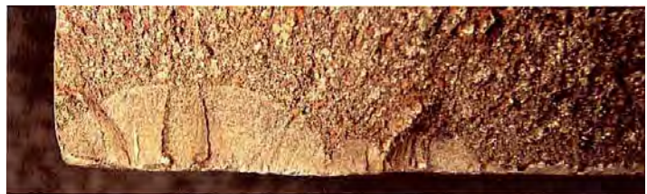
Figur 8 Utmattingsbrudd i nedre venstre del av tverrsnittet. Foto: Teknologisk Institutt.
