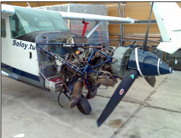
Figur 1. LN-ACZ med bøyd nesehjulslegg.
