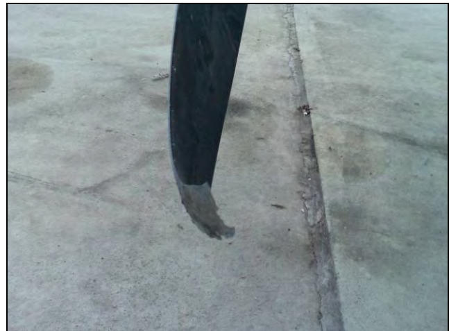
Figur 2. Bøyd propellertipp LN-ACZ.
