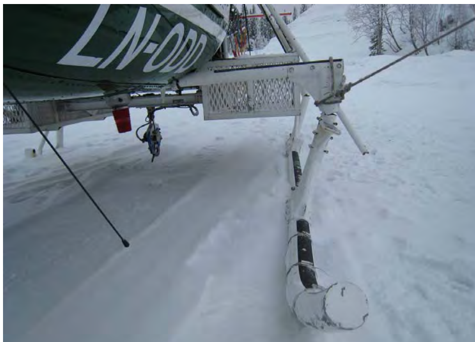
Figur 1: Skade på venstre skid.
