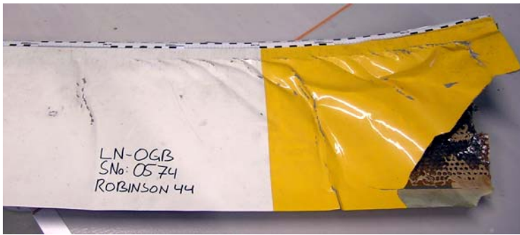
Fig. 5a Mest skadet rotorblad - Overside
