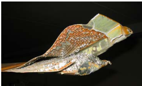
Fig. 5d Ødelagt rotortipp sett skrått bakfra
