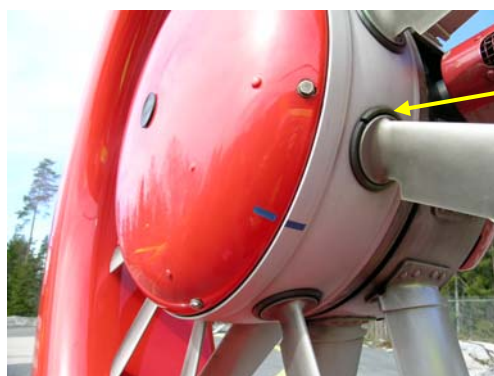
Fig. 6b Illustrasjonsfoto: Uskadet fastmontert deksel med overrettmerke
