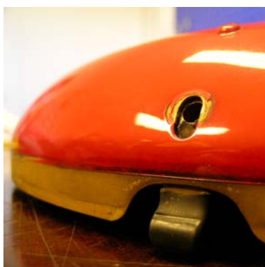
Fig. 6a Illustrasjonsfoto: Deksel med festeklips (Bolt ikke montert)
