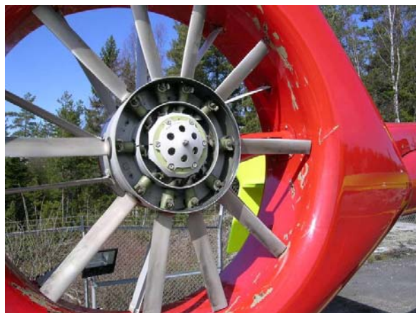
Fig. 4 Skadet tunnel og deformerte bladtipper
