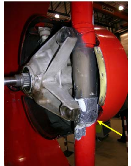
Figur 11: Bilde tatt fra venstre side skrått framover. Pilen peker mot knekkpunktet på "aft attachment tube".
