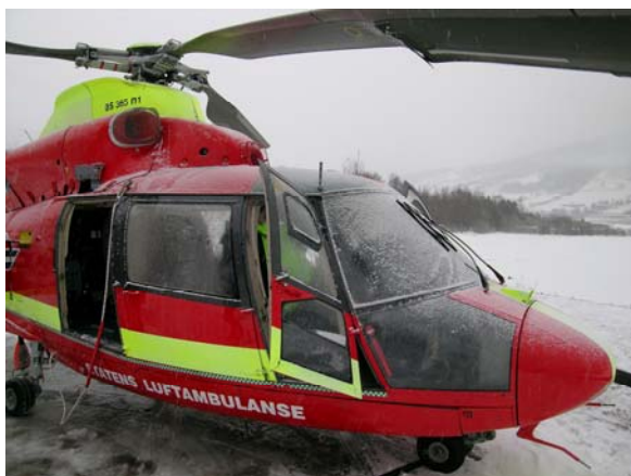
Figur 5: LN-OPJ etter at det var hevet. Den manglende døren, redningslinen og skadene på hovedrotorbladene vises.
