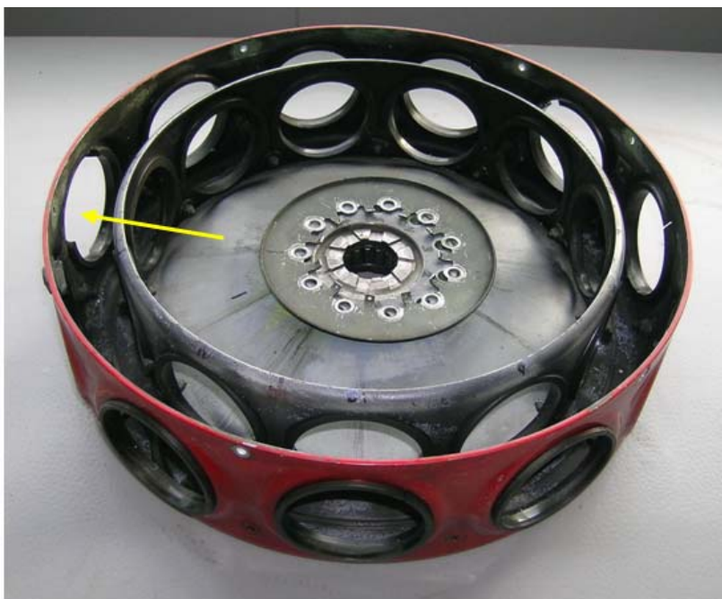
Figur 12: Senteret av haleratoren holder rotorbladene i posisjon ved hjelp av foringer. Pilen markerer en foring som delvis har forsvunnet.
