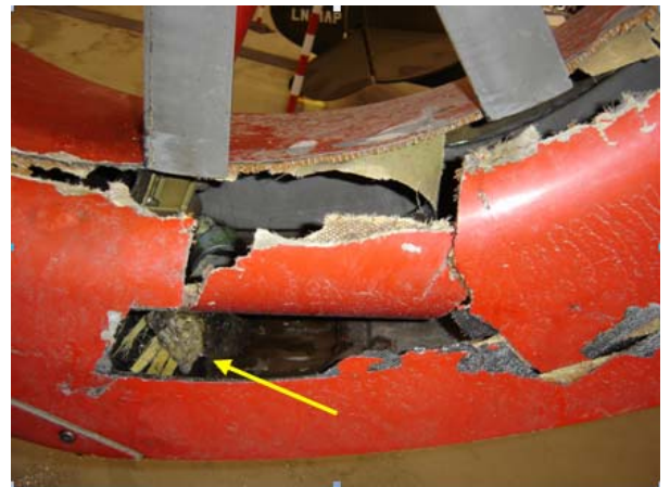
Figur 9: Pilen peker mot en del av et rotorblad som ligger i ett av hullene i tunnelen.
