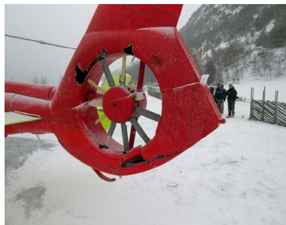
Figur 6: Skadene på Fenestron.
