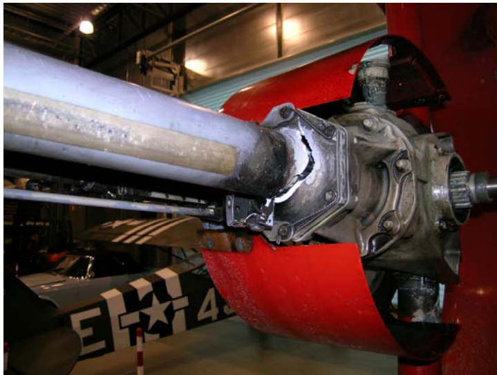
Figur 10: Bilde tatt fra venstre side skrått bakover viser bruddet i "forward attachment coupling tube".
