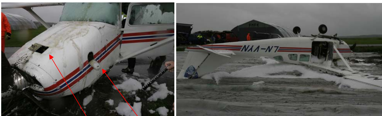
Figur 1: Viser luker ved oljepåfylling og oljepinne. (Foto: politiet)
