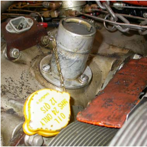
Figur 3: Oljepåfyllingslokk og påfyllingsstuss.
