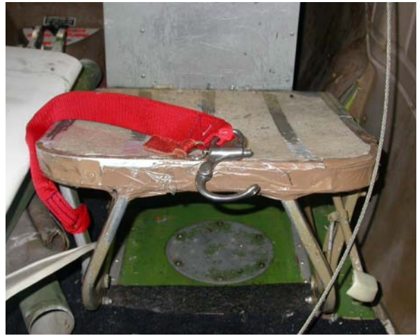
Figur 4: Passasjersele med festestropp. Setet er plassert med ryggen mot flyets fartsretning.
