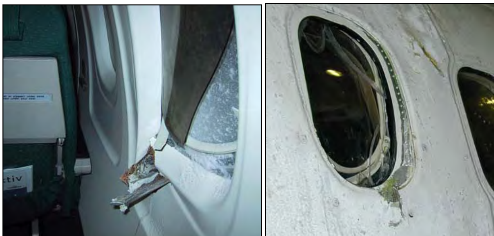
Figur 14: Punktert og penetrert høyre kabinvindu nr. 2, LN-WIN.
