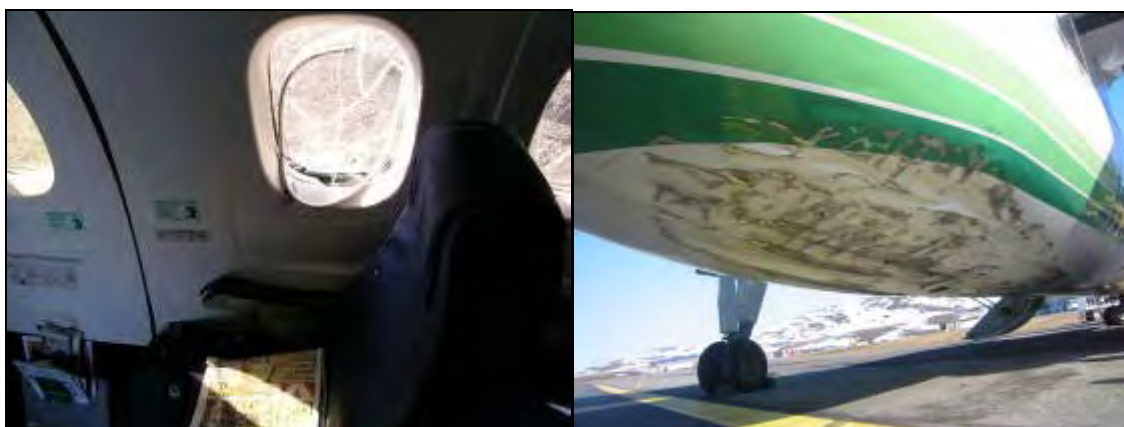
Figur 12: Knust høyre kabinvindu nr. 2 og strukturskader som følge av kontakt med rullebanen.
