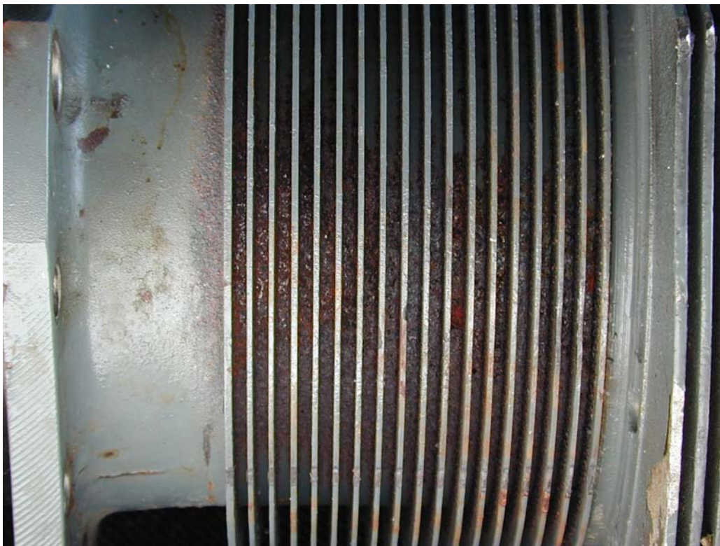
Figur 1 Korrosjon på undersiden av en av de andre sylindrene fra LN-AAJ
