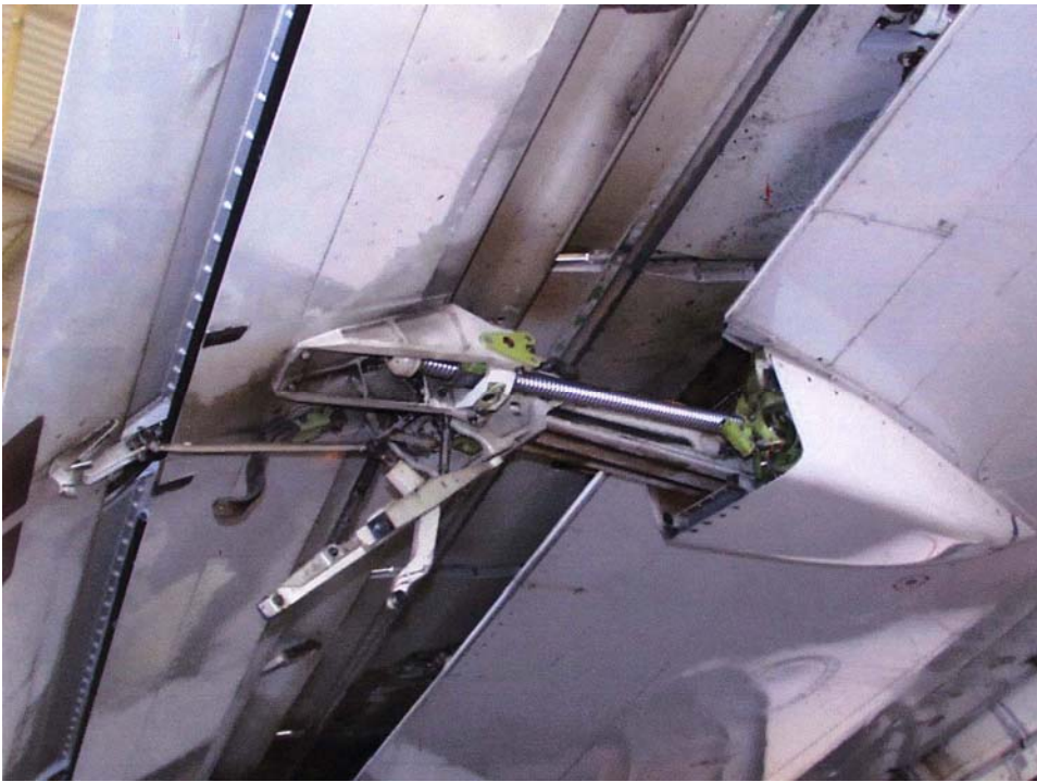
Fig 2 Underside av høyre ving hvor "flap track fairing" mangler.
