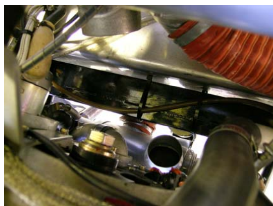
Fig. 3 Fotografi av samme område uten slange. Varmevexleren er synlig nederst. Den sorte konstruksjonen er en del av motorbukken bak motoren.
