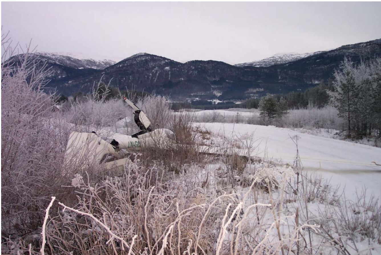
Seilflyet med motoren og propellen utfelt etter ulykken. Rullebanen vises i senter av bildet
