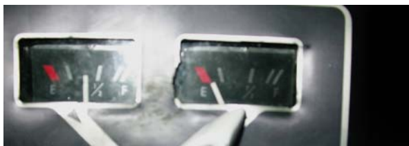
Foto nr. 3: Indikasjon etter havariet.
