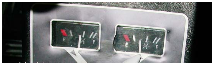
Foto nr. 4: Indikasjon etter påfylt ca. 30 liter på høyre tank.
