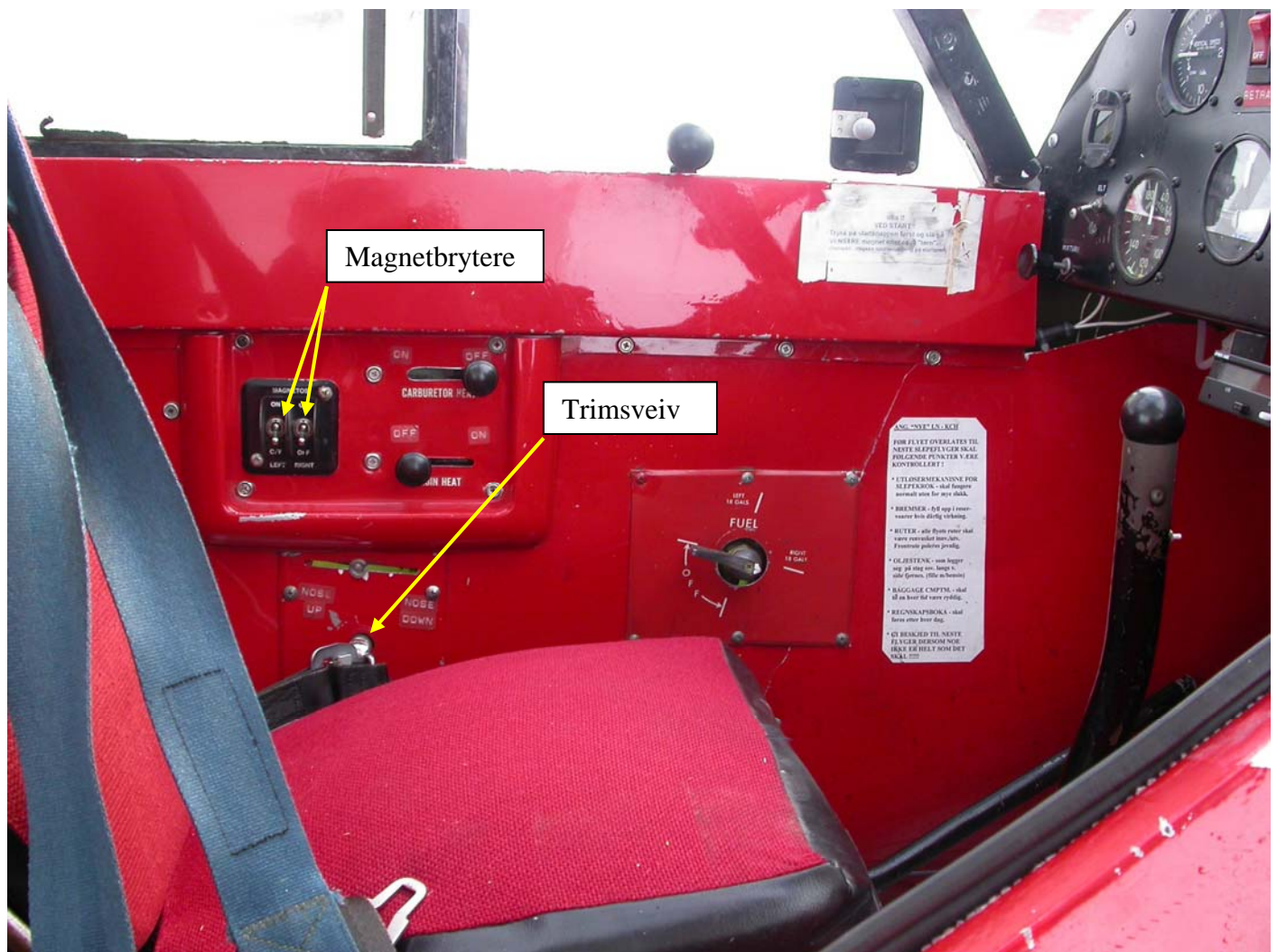
Magnetbrytere og trimsveiv sett fra forsetet på LN-KCH
