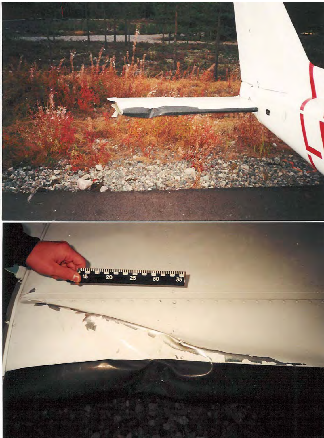
Figure 3. LN-MTD Skader på høyre stabilisator
