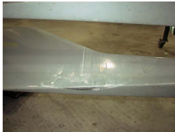
Fig. 2 Skade på gult hovedrotorblad sett fra undersiden (Bladet med størst skade)
