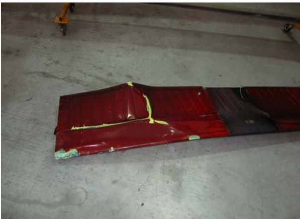
Fig.1 Skade på høyre haleflate sett fra undersiden
