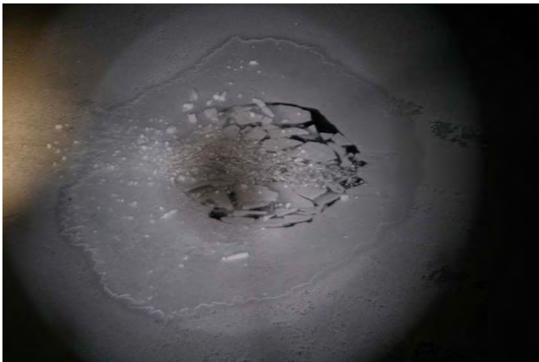
Fig. 3 Fotografi av første hull i isen. Til høyre for hullet skimtes spor i snøen fra understellet. Helikopteret passerte fra høyre mot venstre i bildet.
