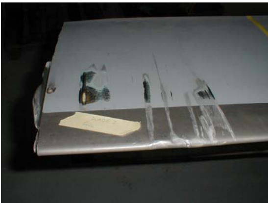
Fig. viser skadene på ett av de tre hovedrotorbladene. (Bladet er fotografert med undersiden opp)
