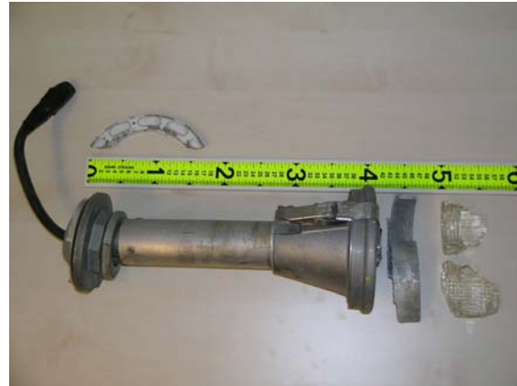
Fig. 4: Rullebanekantlys (vekt 2,9 kg) og bit fra neshjulsfelg (hvit metall) del
